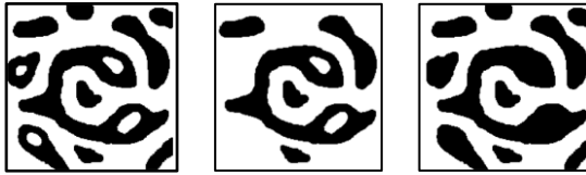
รูปที่ 2.23 การประยุกต์ใช้ Morphological reconstruction กับภาพแบบไบนารี
