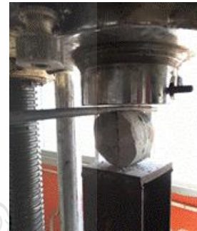
ข) การผ่าซีกตัวอย่างด้วยเครื่อง UTM
