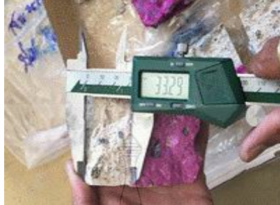
รูปที่ 3.11 การวัดระยะการเกิดคาร์บอนเนชัน
