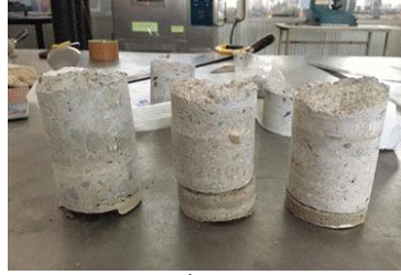
รูปที่ 3.8 แท่งตัวอย่างคอนกรีตที่ได้จากการเจาะเพื่อทดสอบระยะการเกิดคาร์บอนเนชัน
