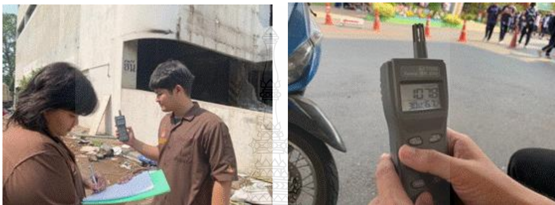
รูปที่ 3.4 การวัดความเข้มข้นก๊าซคาร์บอนไดออกไซด์และความชื้นสัมพัทธ์บริเวณที่อาคารตั้งอยู่
