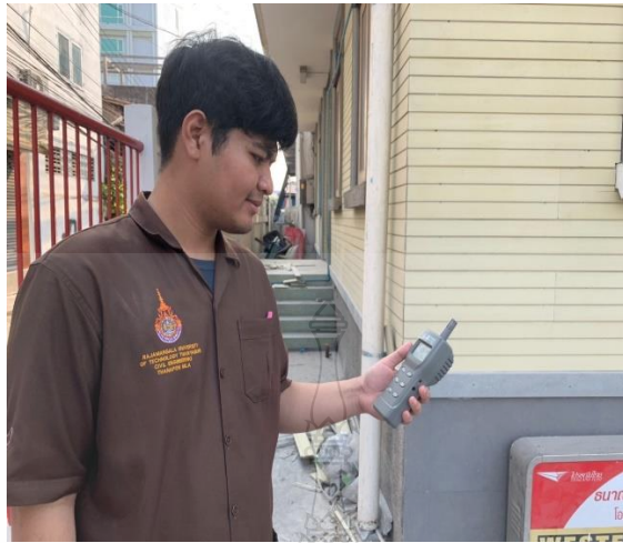
รูปที่ ฉ.3 ทำการวัดปริมาณความเข้มข้นก๊าซคาร์บอนไดออกไซด์และความชื้นสัมพัทธ์ของอากาศ
