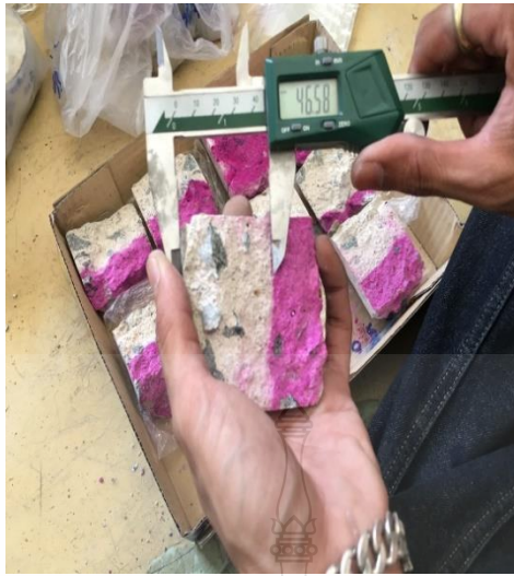
รูปที่ ๑.๑ ทำการวัดระยะการเกิดคาร์บอนเนชั่น
