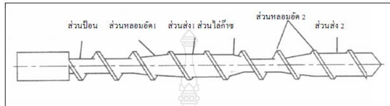
รูปที่ 2.13 สกรูแบบสองขั้น (Two-stage venting screw) [10]
