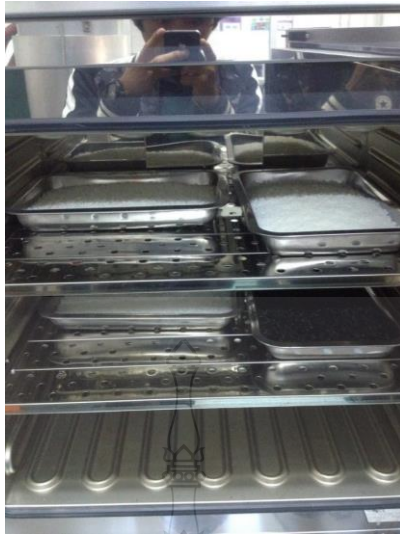
รูปที่ 3.16 เตรียมการอบ PLA เกรด 6100D Masterbatch ถ่านไม้ไผ่ และ Masterbatch PE-g-MA
