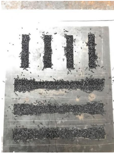
รูปที่ 3.12 แม่พิมพ์ที่ใช้ในการขึ้นรูปชิ้นทดสอบพอลิเมอร์ผสม
