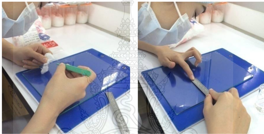
รูปที่ 3.2 การทดสอบความยาวของเส้นใย (ก) การสู่มตัวอย่างเส้นใย (ข) การวัดความยาวเส้นใย
