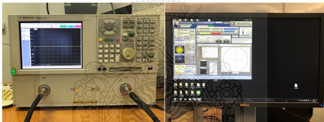
รูปที่ 4.1 เครื่องวิเคราะห์โครงข่าย (Network Analyzer) รุ่น Agilent E8363B
