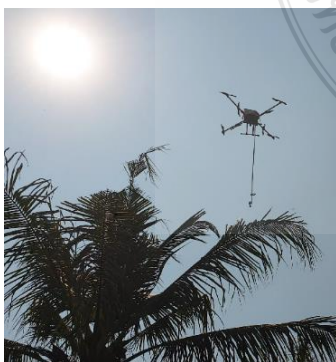
รูปที่ 4.10 แสดงการทดสอบชุดแขนกลพ่นน้ำยาควบคุมระยะไกลแบบติดตั้งกับโดรน สำหรับฉีดพ่นยอดมะพร้าวที่เกิดด้วงเจาะทำลาย
