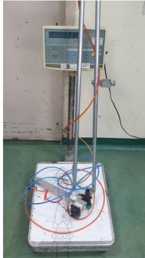
รูปที่ 4.5 แสดงผลการทดสอบน้ำหนักขึ้นส่วนชุดแกนกลพ่นน้ำยา
