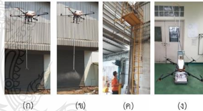
รูปที่ 7 (ก) แสดงการทดสอบกล้อง IP Camera (ข) แสดงการทดสอบหัวฉีดพ่นน้ำยา (ค) แสดงการทดสอบชุดแขนกลพ่นน้ำยา การเคลื่อนที่ ขึ้น-ลง (ง) แสดงการทดสอบน้ำหนักอุปกรณ์
