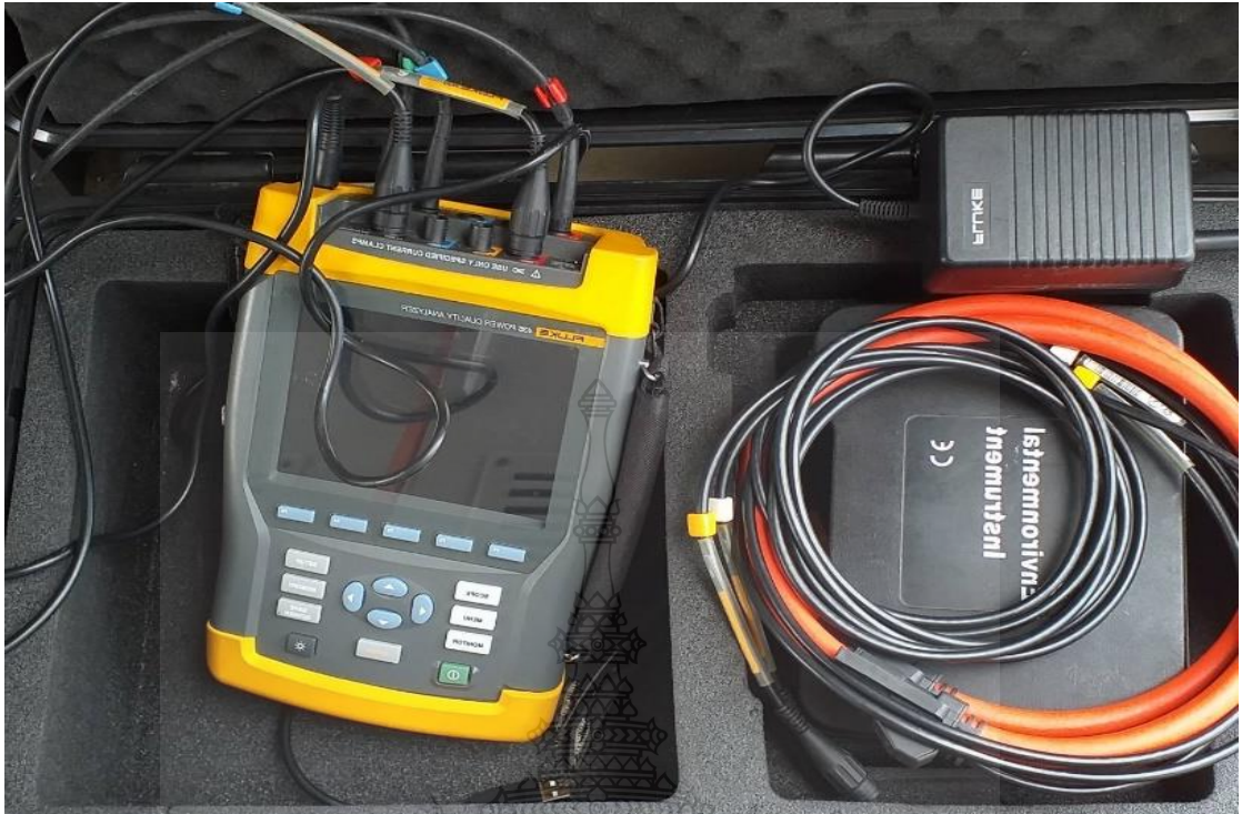
รูปที่ 3.17 เครื่องมือวัดค่าพลังงานงานของแผง และสภาพของแผงเซลล์แสงอาทิตย์ที่ศึกษา
