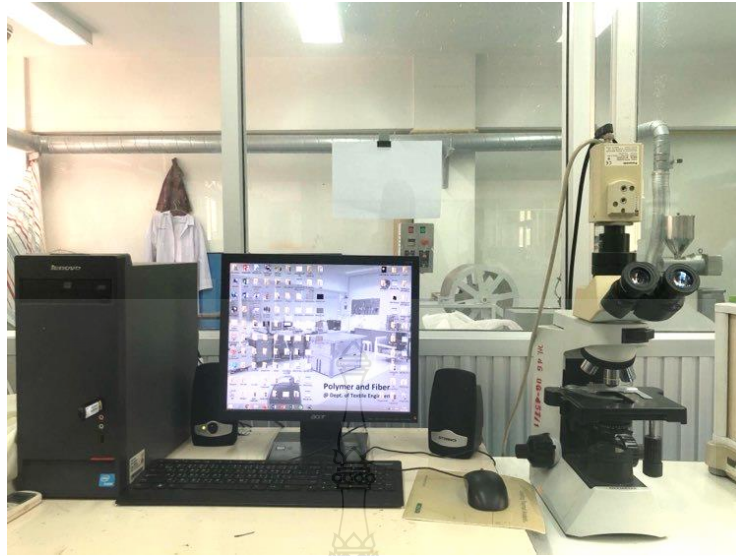
รูปที่ 3.10 กล้องจุลทรรศน์แบบใช้แสง (Optical Microscope, OM)
