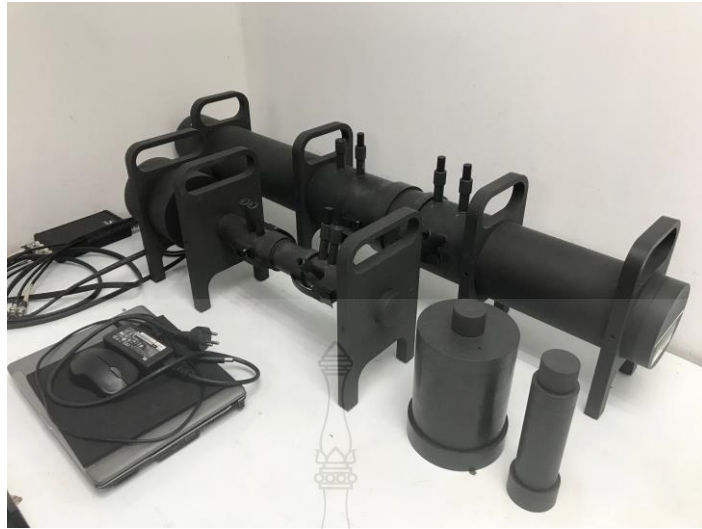
รูปที่ 3.12 เครื่องทดสอบสมบัติทางเสียง (Acoustic Duct)
