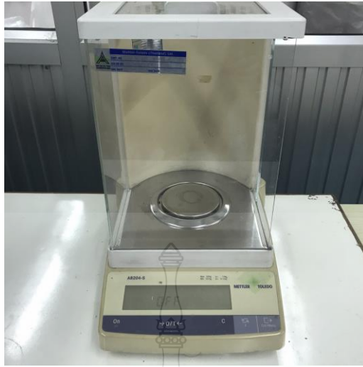
รูปที่ 3.8 เครื่องชั่งน้ำหนัก 4 ตำแหน่ง
