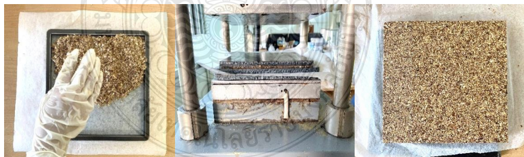
รูปที่ 3.2 วิธีการอัดขึ้นรูปแผ่นอัดเปลือกถั่วลิสง ขนาด 18×18 เซนติเมตร ก) ขั้นตอนการเทส่วนผสมลงแผ่นเตรียมอัด ข) ขั้นตอนการนำแผ่นเตรียมอัดเข้าเครื่องอัดร้อน ค) แผ่นขึ้นไม้อัดเปลือกถั่วลิสง
