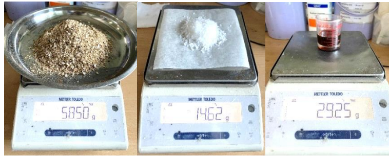
รูปที่ 3.1 การชั่งส่วนผสมของวัสดุและวัสดุประสาน ก) อัตราส่วนเปลือกถั่วลิสง ข) อัตราส่วนพาราฟินแว็กซ์ ค) อัตราส่วนกาวไอโซไซยาเนต
