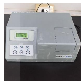
ภาพที่ 12 แสดงขั้นตอนการวิเคราะห์ปริมาณวิตามินซีโดยเทคนิคสเปกโตรโฟโตเมตรี
