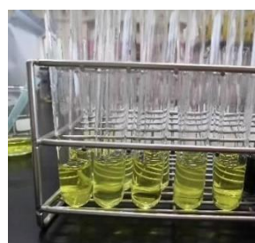
ภาพที่ 11 แสดงขั้นตอนการเตรียมกราฟมาตรฐานของสารละลายมาตรฐานกรดแอสคอร์บิก
