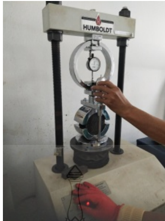
รูปที่ 3.4 การทดสอบแอสฟัลต์คอนกรีตโดยวิธีมาร์แชลล์
