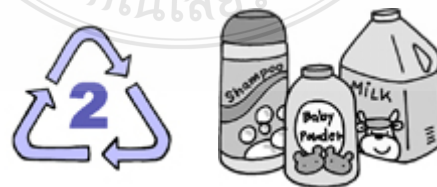
รูปที่ 2.8 พอลิเอทิลีนความหนาแน่นสูง [13]
