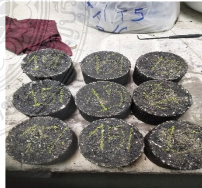
(ฉ) ตัวอย่างทดสอบที่ได้หลังจากดันก้อนตัวอย่าง
