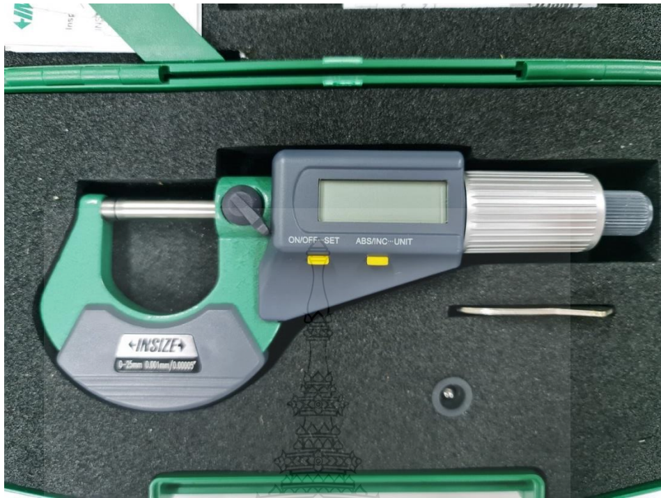
รูปที่ ข.5 เครื่องทดสอบความหนา ยี่ห้อ INSIZE รุ่น Digital Outside Micrometer 3109
