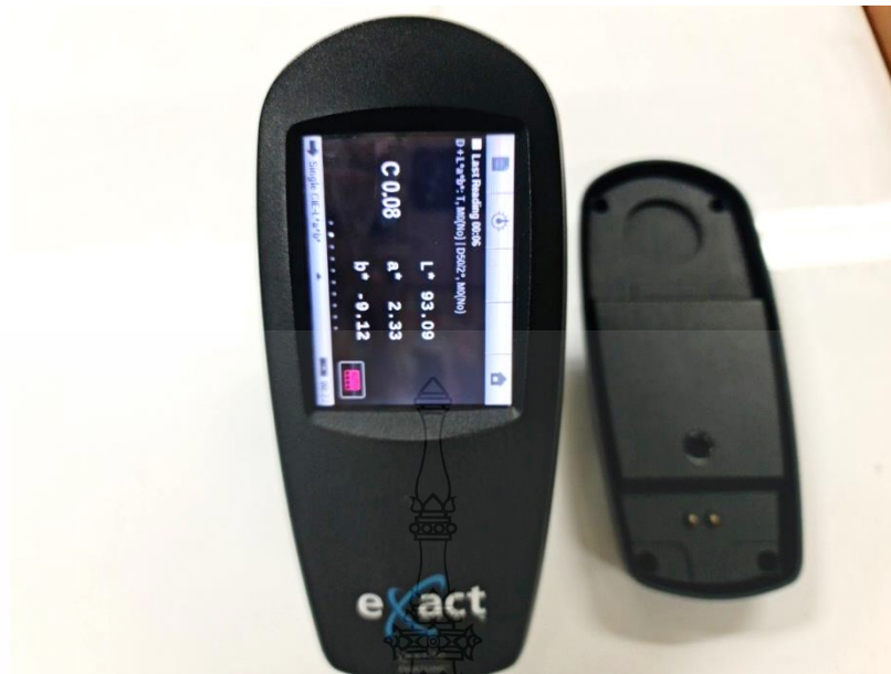
รูปที่ ข.3 เครื่องวัดค่าสี EXACT รุ่น X - RITE PANTONE
