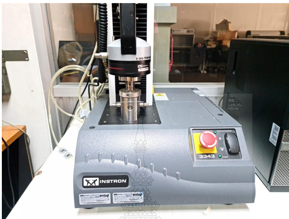
รูปที่ ข.1 เครื่องทดสอบความต้านแรงดึง ยี่ห้อ INSTRON รุ่น 3343
