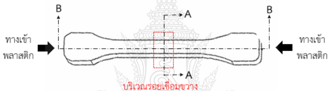
รูปที่ 4.12 บริเวณชิ้นงานทดสอบสัณฐานวิทยา
