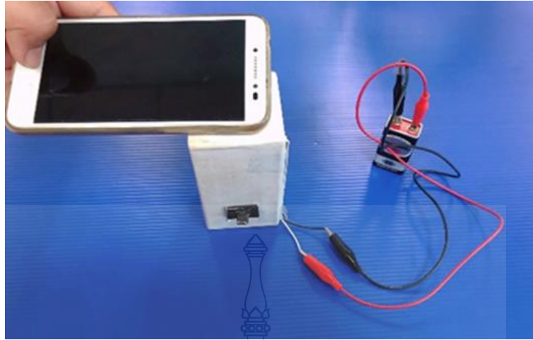
ภาพที่ 4.2 กล่องที่บแสงสำหรับถ่ายภาพแผ่นทดสอบแบบกระดาศ
