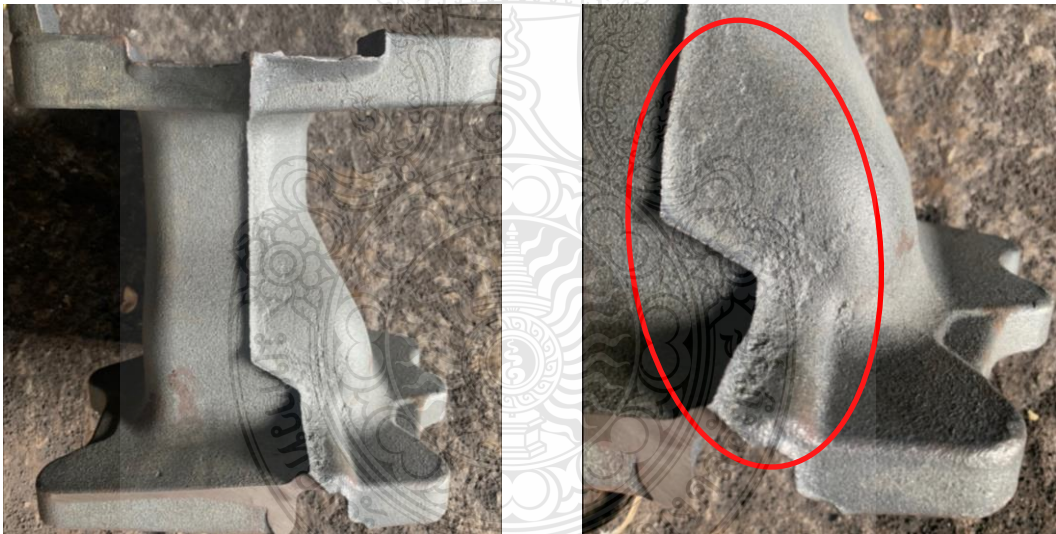
ภาพที่ 3.16 ลักษณะของเสียประเภทผิวงานไม่เรียบ
