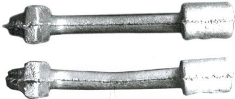
ภาพที่ 2.26 การบิดงอของชิ้นงานอะลูมิเนียมที่รูปแบบหล่อเร็วเกินไป [5]
