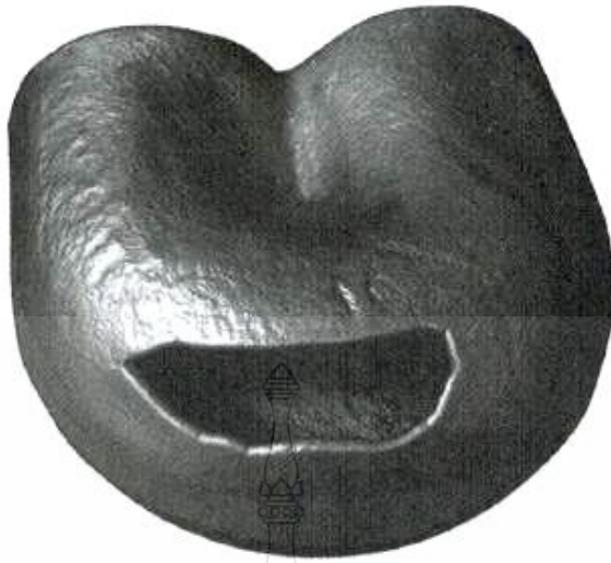
ภาพที่ 2.10 ลักษณะจุดบกพร่องของการวิ่งไม่เต็มแบบ [5]
