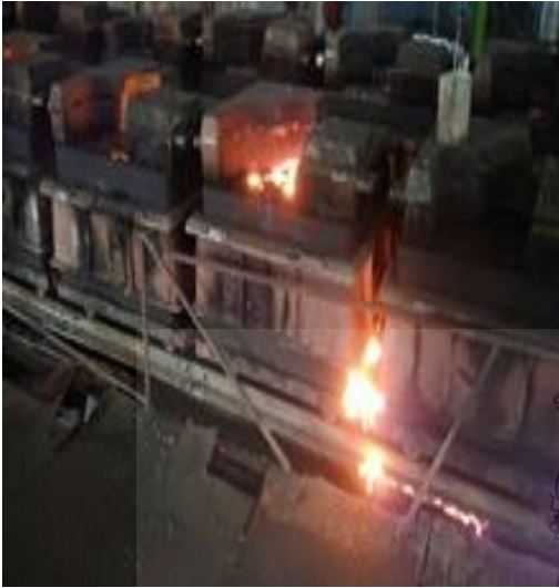
ภาพที่ 3.13 ลักษณะของเสียประเภทชิ้นงานไม่เต็มแบบ
