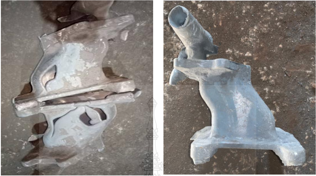
ภาพที่ 3.15 ลักษณะของเสียประเภทเหล็กเข้าไม่เต็มแบบ
