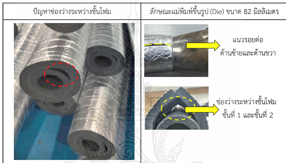
รูปที่ 4.10 ปัญหาของเสียช่องว่างระหว่างชั้นโฟมและการเลือกใช้แม่พิมพ์ขึ้นรูป (Die)
