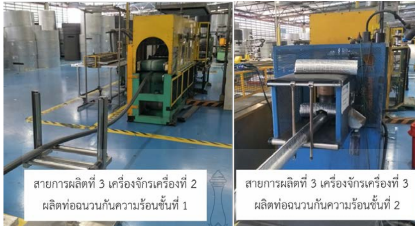
รูปที่ 3.4 ลักษณะเครื่องจักรที่ใช้ผลิตท่อฉนวนกันความร้อน
