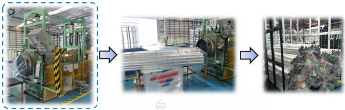
รูปที่ 2.20 ลักษณะของเครื่องช่วยบรรจุผลิตภัณฑ์ที่อุณหภูมิความร้อน (Semi auto packing machine)
