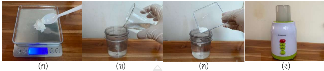
รูปที่ ๓.๓ (ก) ชั่งโซเดียมอัลจิเนต (ข) ตวงปริมาณน้ำ (ค) เทส่วนผสมใส่เครื่องปั่น และ (ง) ปั่นผสมสารละลายกับน้ำให้เข้ากัน
