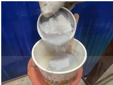
รูปที่ 3.15 ชั่งผงอลูมิเนียม (Aluminium) ผงคาร์บอนแบล็ค (Carbon black Powder) และผงเหล็ก (Ferro Powder)
