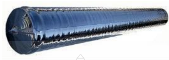
รูปที่ 2.18 ผลึกเดี่ยวของซิลิกอนบริสุทธิ์
