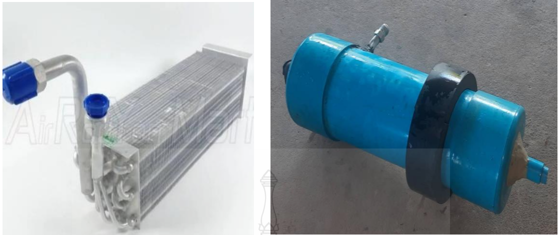
รูปที่ 3.8 แสดงเครื่องแลกเปลี่ยนความร้อนแบบเปลือกและท่อโดยติดตั้งอีแวปโปเรเตอร์อยู่ด้านใน
