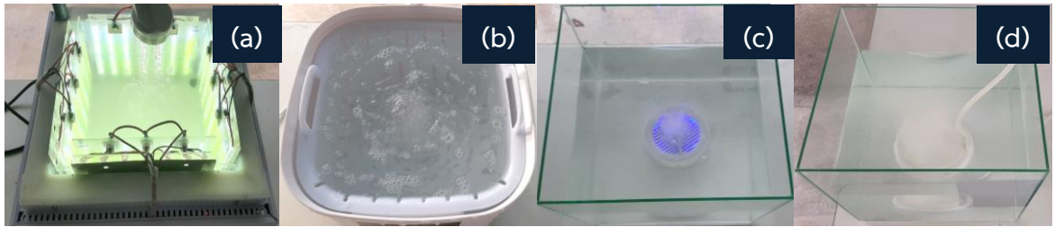
ภาพที่ 4.22 การศึกษาการกำจัดยาฆ่าแมลงความเข้มข้น 3 ppm ในสารละลายปริมาตร 10 ลิตร ด้วยระบบที่แตกต่างกัน คือ (a) PEC, (b) Ozone 1, (c) Electrolyte, และ(d) Ozone 2
