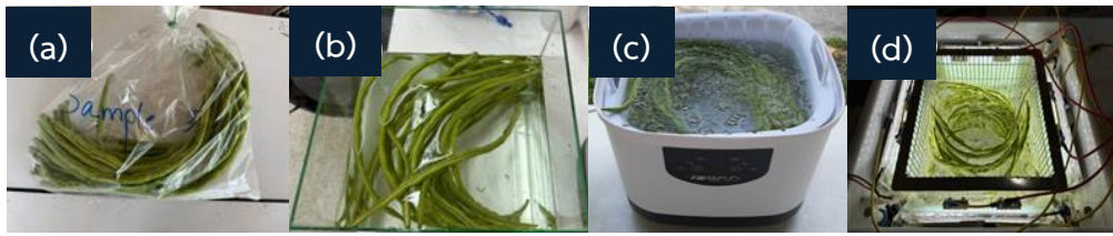
ภาพที่ 4.34 แสดงภาพการทดลองของการล้างผักถั่วฝักยาว (a) control, (b)การแช่ด้วย NaCl, (c)การล้างด้วยเครื่องล้างผักโอโซน (Ozone) และ(d)เครื่องล้างผักด้วยกระบวนการโฟโตอิเล็กโทรคะตะไลติก (PEC)
