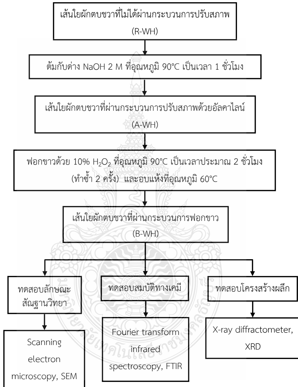
รูปที่ 3.1 ขั้นตอนการเตรียมเส้นใยไมโครเซลลูโลสผ่านกระบวนการปรับสภาพด้วยอัลคาไลน์และกระบวนการฟอกขาว
