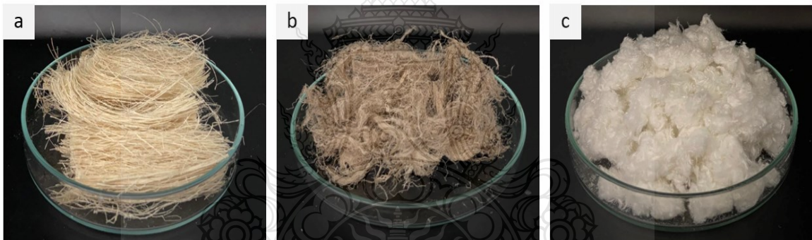
รูปที่ 4.1 (a) เส้นใยผักตบชวาที่ไม่ได้ผ่านกระบวนการปรับสภาพ (R-WH), (b) เส้นใยผักตบชวาที่ผ่านกระบวนการปรับสภาพด้วยอัลคาไลน์ (A-WH) และ (c) เส้นใยผักตบชวาที่ผ่านกระบวนการฟอกขาว (B-WH)
