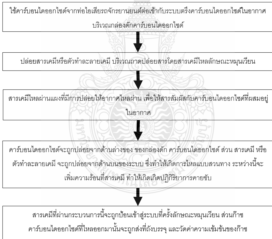
รูปที่ 3.8 ขั้นตอนการทดสอบระบบการตรึง คาร์บอนไดออกไซด์ในอากาศ
