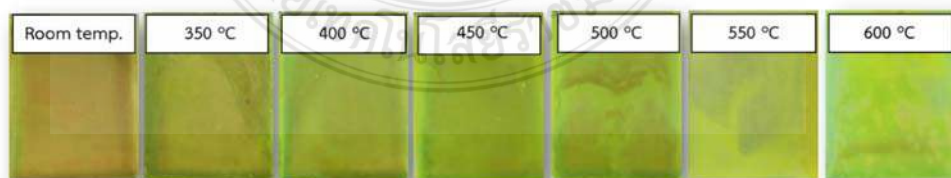
ภาพที่ 4.13 ลักษณะทางกายภาพของชีวไฟฟ้า FTO/WO 3 /BiVO 4 ที่มีการเผาชีวไฟฟ้าที่อุณหภูมิแตกต่างกัน ดังนี้ อุณหภูมิห้อง (RT), 350 °C, 400 °C, 450 °C, 500 °C, 550 °C, และ 600 °C
