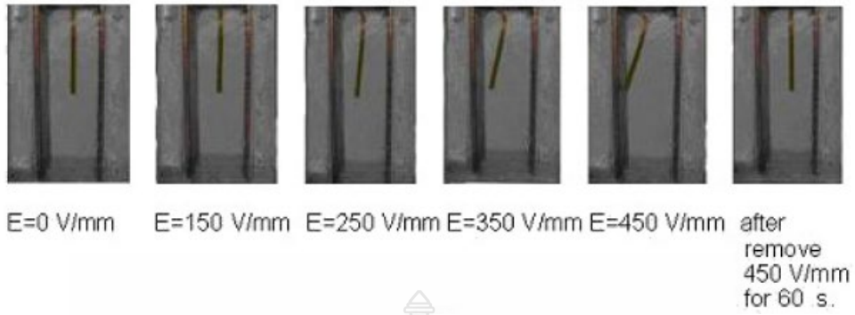
รูปที่ 2.49 การเบี่ยงเบนของฟิล์มตามความแรงของสนามไฟฟ้า [6]
