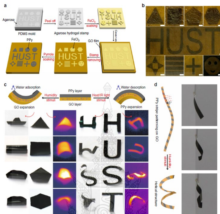
รูปที่ 2.37 การประดิษฐ์และการเปลี่ยนแปลงโครงสร้างตัวกระตุ้น a) รูปแบบ PPy บนฟิล์ม GO สำหรับการสร้างไฟตัวกระตุ้น GO/PPy b) ภาพ PPy บนฟิล์ม GO c) กลไกการทำงานของตัวกระตุ้นสองชั้น GO/PPy และการเปลี่ยนแปลงโครงสร้างของตัวกระตุ้นที่มีรูปสามเหลี่ยมปกติ รูปสี่เหลี่ยมจัตุรัส รูปห้าเหลี่ยมปกติ หกเหลี่ยมปกติและรูปแบบ H-, U-, S- และ T ภายใต้สิ่งเร้าของความชื้นและแสง IR d) ตัวกระตุ้น GO / PPy [40]
