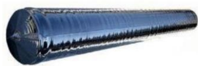
รูปที่ 2.2 ผลึกเดี่ยวของซิลิกอนบริสุทธิ์ [10]
