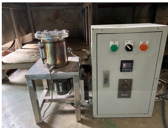
รูปที่ 3.1 ชุดเครื่องปฏิกรณ์แบบควบคุมอุณหภูมิ ขนาด 200 มิลลิลิตร
