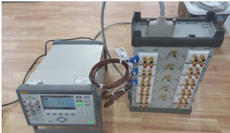
ภาพที่ 3.2 แสดงเครื่องวัดอุณหภูมิความแม่นยำสูง Fluke Calibration 1586A SUPER-DAQ [3]
