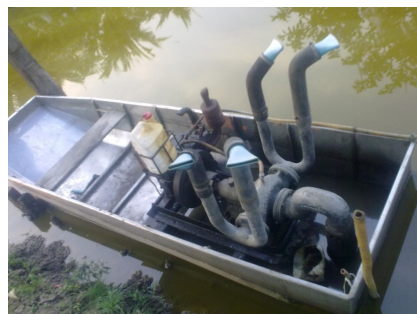
รูปที่ 5 เรือคาน้ำใช้เครื่องยนต์ดีเซลขนาด 7 แรงม้า
