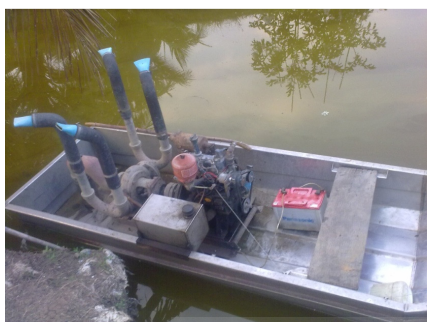
รูปที่ 6 เรือร่อนน้ำใช้เครื่องยนต์ดีเซลขนาด 18 แรงม้า
