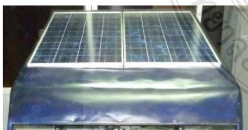
รูปที่ 12 แผงเซลล์แสงอาทิตย์บนหลังคารถไฟฟ้า
