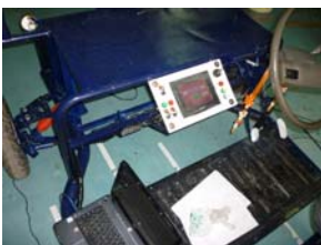
ก) แผงคอนโซลควบคุมรถ
