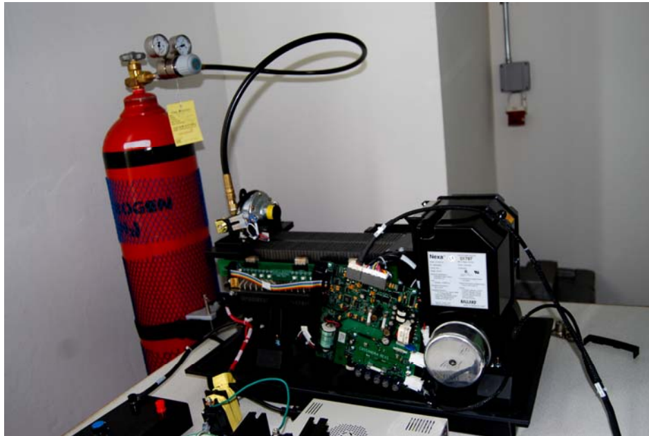
รูปที่ 3.11 การต่อถังไฮโดรเจนกับชุดเซลล์เชื้อเพลิง
