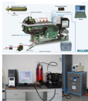
รูปที่ 2: การติดตั้งส่วนประกอบต่างๆ ของ Module ที่ทำการทดสอบ
