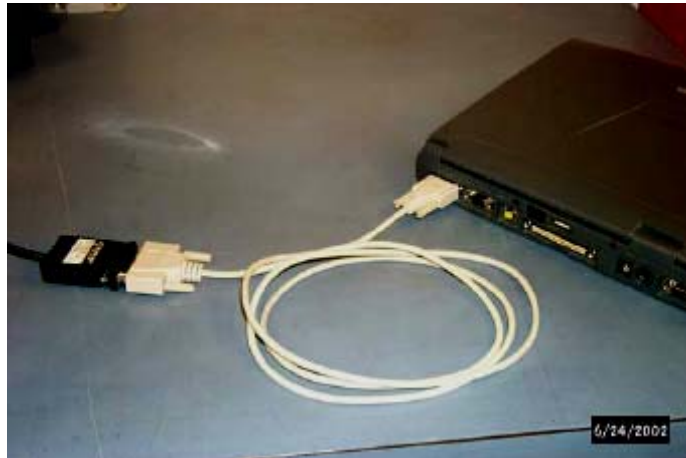
รูปที่ 3.9 การต่อสายสัญญาณ RS485/232 กับคอมพิวเตอร์
