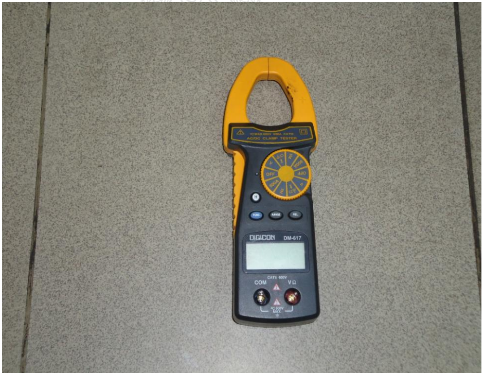
รูปที่ ก.10 เครื่องมือวัดกระแส (Clip amp)
