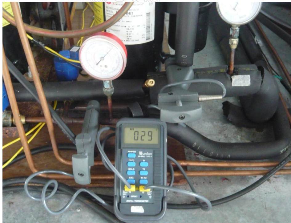
รูปที่ ก.12 การวัดอุณหภูมิของสารทำความเย็น
