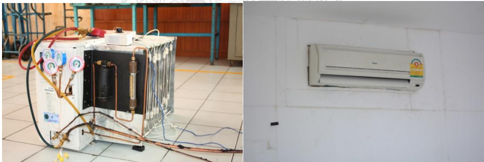
รูปที่ 3.8 เครื่องปรับอากาศที่ใช้ในการทดลอง
