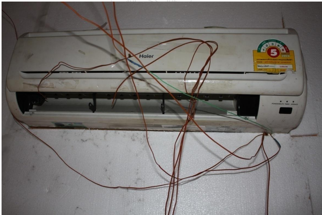
รูปที่ ก.18 ติดตั้งสายวัดอุณหภูมิสารทำความเย็น
