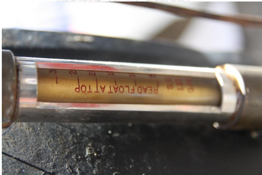
รูปที่ ก.4 เครื่องวัดอัตราการไหลของสารทำความเย็น
