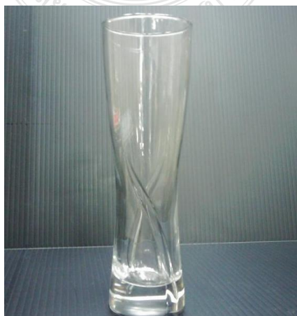
รูปที่ 4.4 แก้วตัวอย่างที่ได้จากการทดสอบแม่พิมพ์
