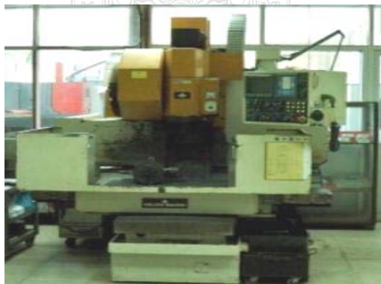
รูปที่ 3.12 เครื่อง CNC Milling SHI ZUOKA ที่ใช้ในงานศึกษาวิจัย
