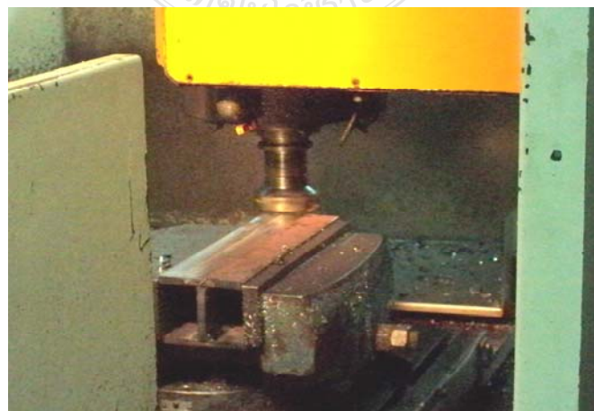
รูปที่ 3.67 การไสหลังคานประกอบเพื่อให้ผิวเรียบ
