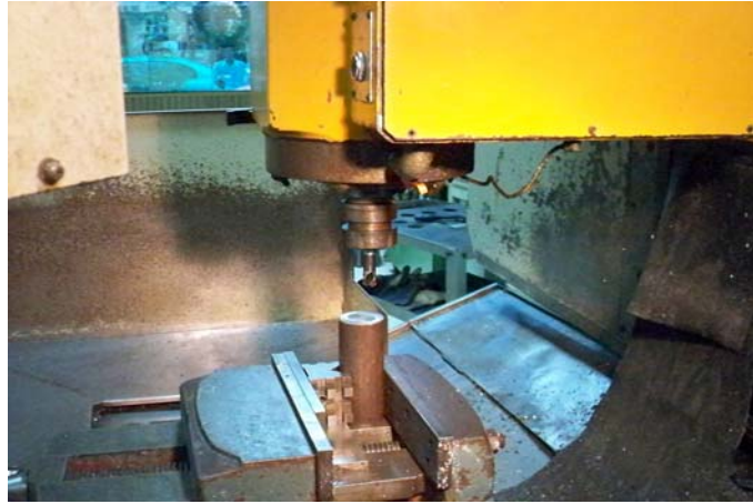
รูปที่ 3.71 ติดตั้งดอกกัดสำหรับการกลึงด้วยเครื่อง CNC
