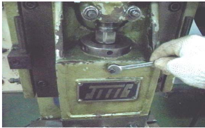
รูปที่ 3.92 ขันน็อต (Nut) ล็อคยึดแกนเหล็กก้านหรือเหล็กเพลาส่งกำลัง ไม่ให้เกินระยะที่ตั้ง
