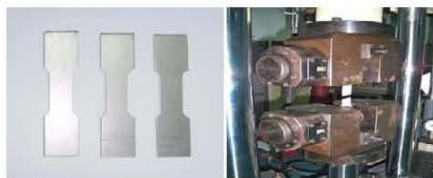
รูปที่ 4 ชิ้นทดสอบสำหรับทดสอบแรงดึง ข) หัวจับทำการดึงชิ้นทดสอบ
