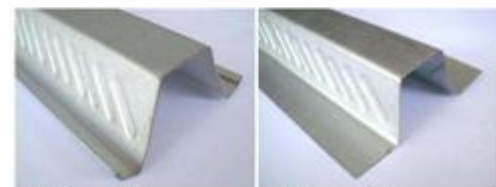
จ) ป้อนขึ้นลอนหน้าตัดแบบ Top Span ฉ) ป้อนขึ้นลอนหน้าตัดแบบ Top Hats ภาพที่ 10 การป้อนขึ้นลอนตัวอย่างคานหน้าตัดรูปทรงหามวกด้านข้างแนวเฉียง
