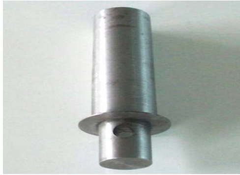
รูปที่ 3.65 ขนาดแกนเหล็กยึดหัวปั๊มแม่พิมพ์ตัวผู้ (Punch)
