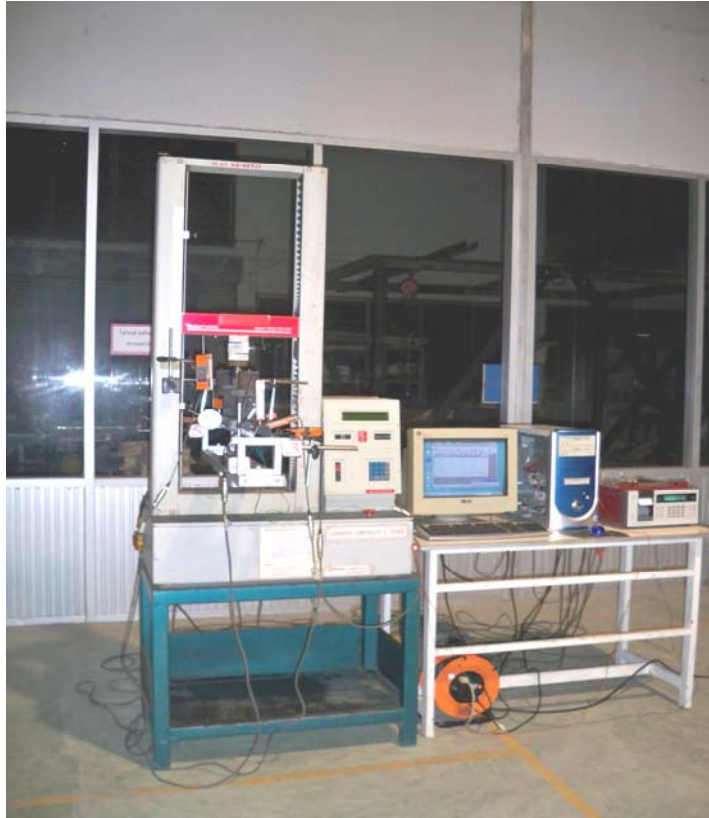
รูปที่ 3.43 เครื่องมือ อุปกรณ์ที่ใช้ทดสอบและตำแหน่งที่กวดคาน บนจตุรรองรับเอียงทำมุม 0 องศา
