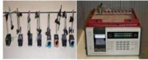
ก) Magnetic สำหรับติดตั้งเครื่องมือ ข) เครื่องบันทึกข้อมูล Data Logger
