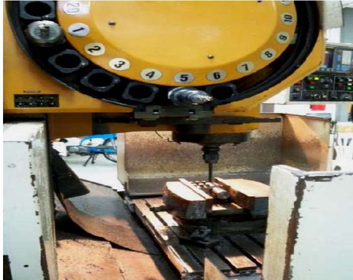
รูปที่ 3.77 เครื่อง CNC ที่ใช้เจาะแกนเหล็กเพื่อยึดสลัก
