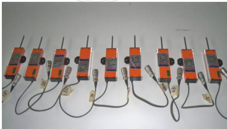
รูปที่ 3.30 เครื่อง Transducer Displacement
