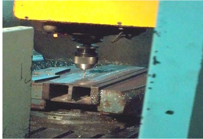
รูปที่ 3.68 การเจาะหลังคานประกอบเพื่อนำร่อง
