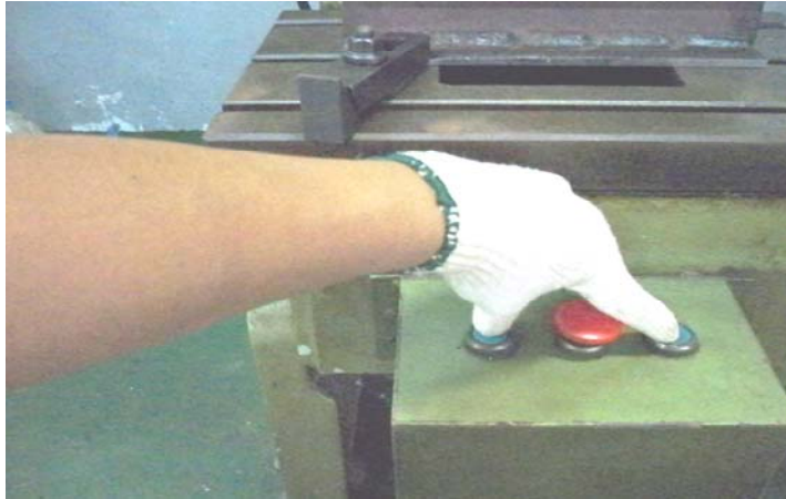
รูปที่ 3.97 กดสวิทซ์สีเขียวขณะทำการป้อนวัสดุ
