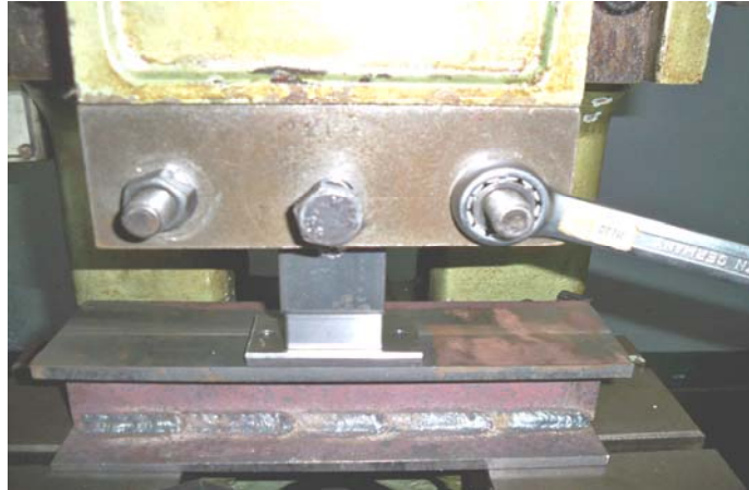
รูปที่ 3.82 ขยับลงจนอยู่ในตำแหน่งที่แม่พิมพ์ตัวผู้และแม่พิมพ์ตัวเมียวางประกบกันได้สนิท
