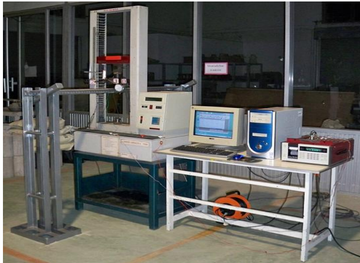
รูปที่ 3.39 เครื่องมือ อุปกรณ์ที่ใช้ทดสอบและตำแหน่งที่กวดคาน บนจตุรกรับเอียงทำมุม 30 องศา
