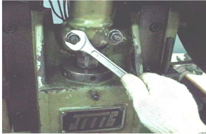
รูปที่ 3.91 ขันน็อต (Nut) ล็อคยึดแกนเหล็กก้านหรือเหล็กเพลาส่งกำลัง
