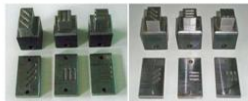
จ) แม่พิมพ์สำหรับหน้าคัต Top Span ฉ) แม่พิมพ์สำหรับหน้าคัต Top Hats
