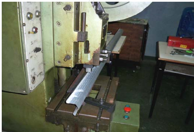
รูปที่ 3.101 ทำการป้อนชิ้นลอนด้านข้างแนวนอน
