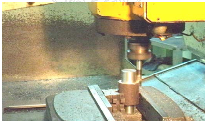
รูปที่ 3.73 การใช้ดอกกัดกลึงครึ่งสองที่ส่วนยึดจับแกนเหล็กกับเครื่องปั๊มข้อเสื่อ (Mechanical Press)
