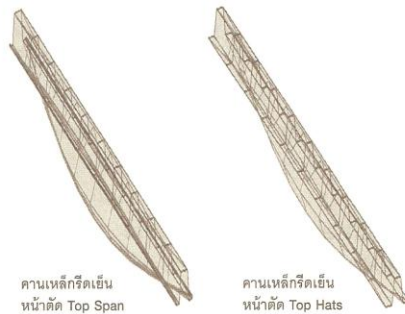
รูปที่ 1 การสร้างแบบจำลองทางคณิตศาสตร์ด้วยวิธีวิเคราะห์แบบ Finite Strip Method
