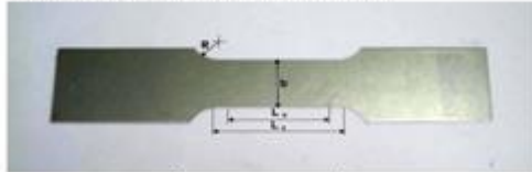
ภาพที่ 11 รูปร่างและมิติของชิ้นทดสอบ
