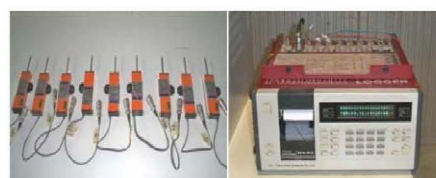
ก) เครื่อง Transducer Displacement ข) เครื่องบันทึกข้อมูล Data Logger
