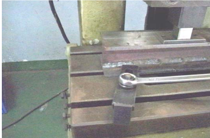
รูปที่ 3.85 การขันลึอกยึดคานประกอบรูปตัวไอด้วยเหล็กประกบ
