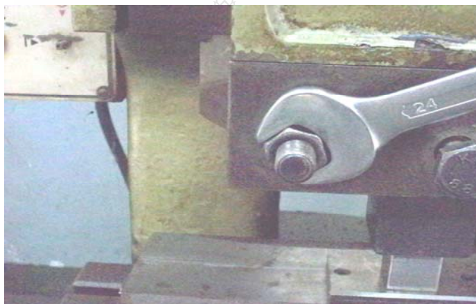
รูปที่ 3.83 ขันน็อต (Nut) ยึดจับแกนเหล็กที่จับล็อกยึดแม่พิมพ์ตัวผู้
