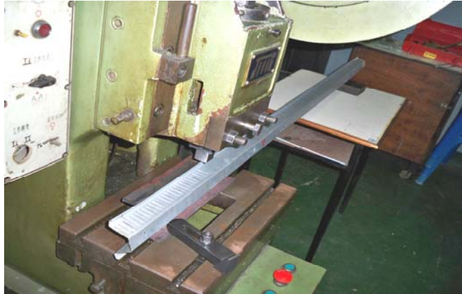
รูปที่ 3.100 ทำการป้อนชิ้นลอนด้านข้างแนวตั้ง
