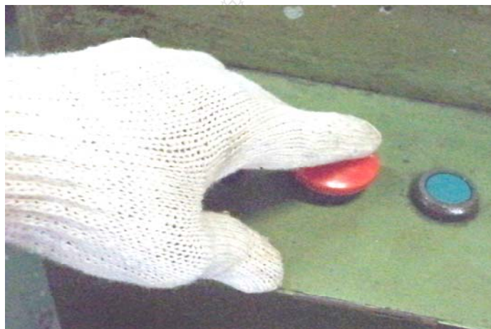
รูปที่ 3.98 กดสวิทซ์สีแดงเมื่อหยุดการทำงานและล็อคเครื่องไม่ให้ทำงาน
