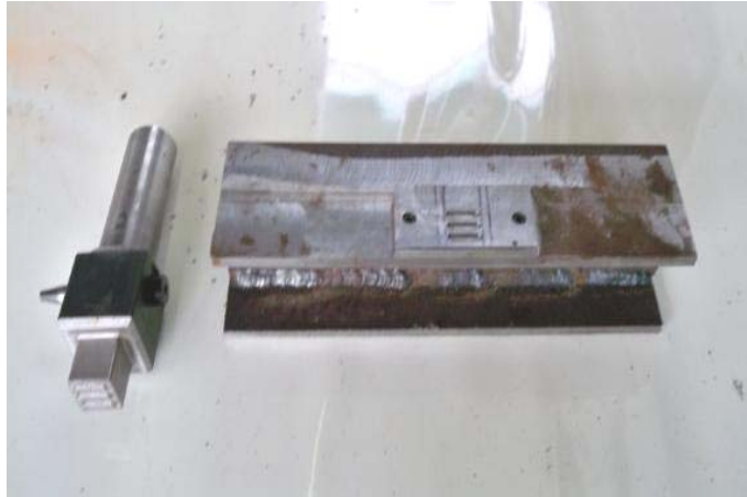
รูปที่ 3.79 คานประกอบรูปตัวไอและแกนเหล็กยึดหัวปั๊มแม่พิมพ์
