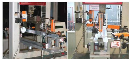
ก) ติดตั้งเครื่องมือวัดคาน Top Span ข) ติดตั้งเครื่องมือวัดคาน Top Hats
