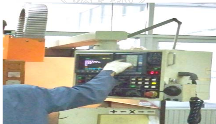
รูปที่ 3.15 การปรับแต่งการทำงานของเครื่องแกะสลักทำแม่พิมพ์
