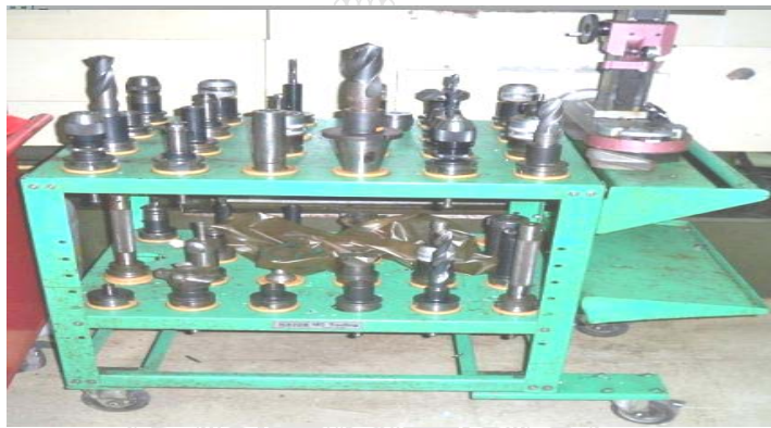
รูปที่ 3.17 ชุดหัวกัดแกะสลักสำหรับเครื่อง CNC
