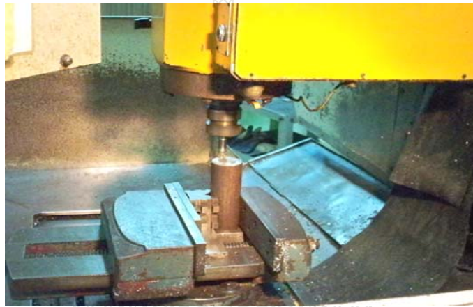
รูปที่ 3.71 ติดตั้งดอกกัดสำหรับการกลึงด้วยเครื่อง CNC
