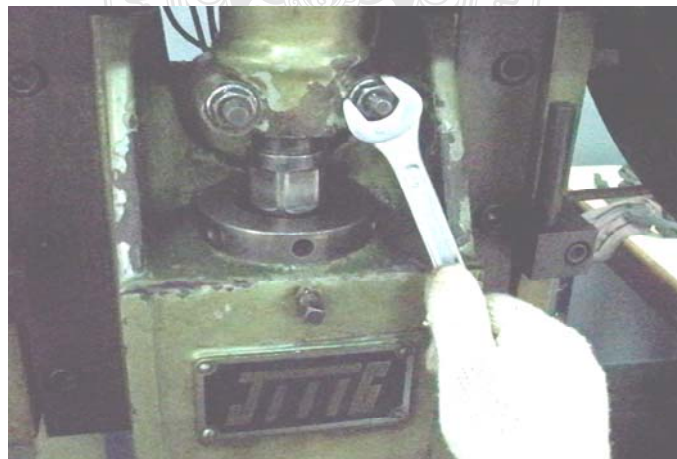
รูปที่ 3.89 ชั้นเหล็กแกนเพลาส่งกำลังของเครื่องปั๊มปรับระยะตั้งค่า Stroke (ขึ้น-ลง)
