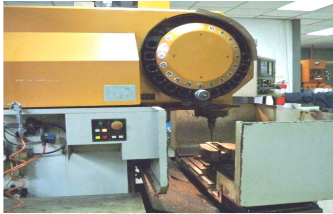
รูปที่ 3.20 การเจาะเพื่อยึดหัวป้อนแม่พิมพ์ด้วยสลักขนาดเส้นผ่านศูนย์กลาง 12 มิลลิเมตร
