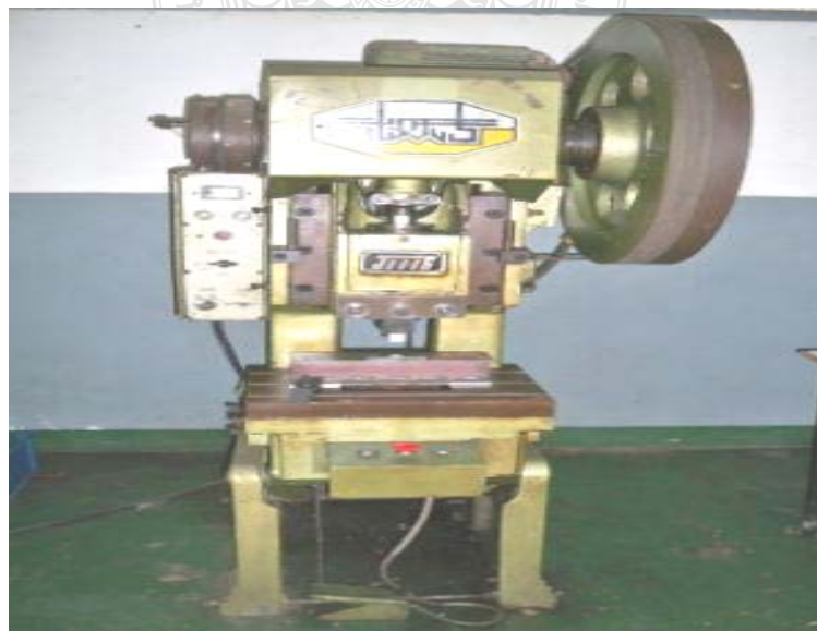
รูปที่ 3.78 เครื่องปั๊มข้อเสื่อ (Mechanical Press)
