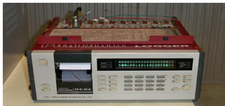
รูปที่ 3.33 เครื่องบันทึกข้อมูล Data Logger
