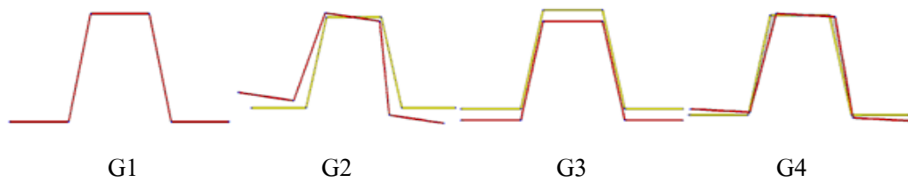
รูปที่ 4.30 หน้าตัดคาน Top Span ที่เกิดการเคลื่อนตัวเมื่อรับแรงกดตัดและเกิดการเสียรูปแบบ โกงเดาะรวม (Global Buckling) G1 ถึง G4
