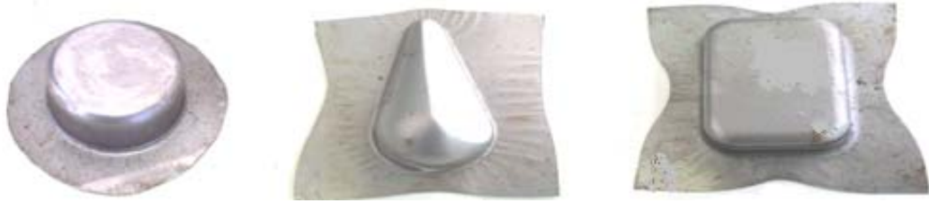
รูปที่ 3.61 ตัวอย่างที่ทำการทดสอบการลากขึ้นรูป (Deep Drawing)
