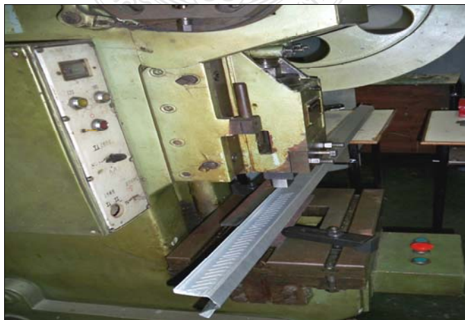
รูปที่ 3.99 ทำการป้อนชิ้นลอนด้านข้างแนวเฉียงเอียง
