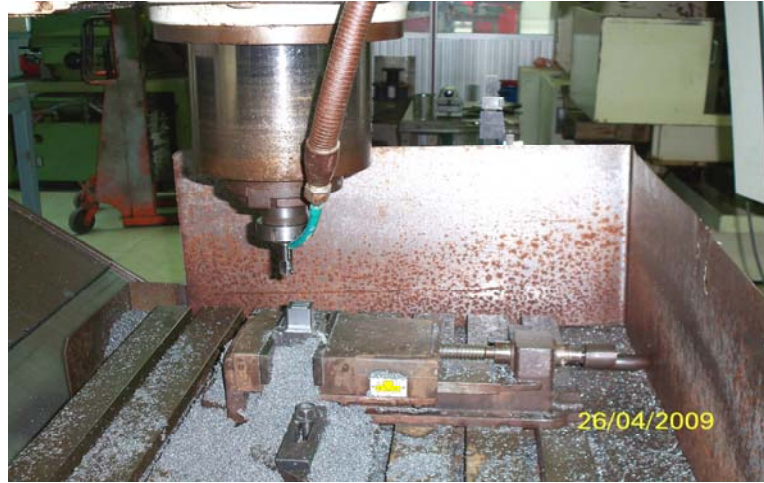
รูปที่ 3.19 แม่พิมพ์ตัวผู้ (Punch) ที่ชุดหัวกัดแกะสลักเสร็จแล้ว
