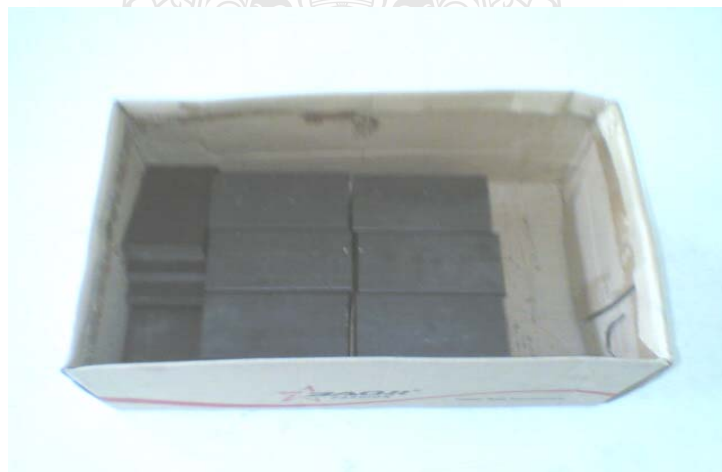
รูปที่ 3.2 เหล็กหัวแดงสำหรับเป็นวัสดุที่ใช้สร้างแม่พิมพ์
