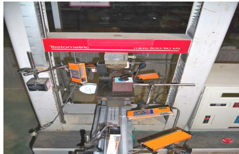
รูปที่ 3.46 ติดตั้งเครื่องมือวัดในตำแหน่งที่มีการเคลื่อนตัวและต้องการดูผลการเสียรูปของคานเหล็กรีดเย็น
