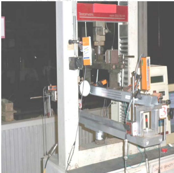
รูปที่ 3.44 ติดตั้งเครื่องมือวัดในตำแหน่งที่มีการเคลื่อนตัวและต้องการดูผลการเสียรูปของคานเหล็กรีดเย็น
