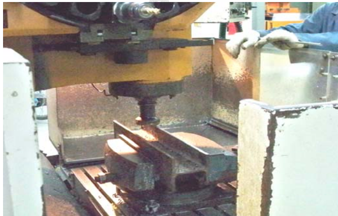
รูปที่ 3.66 การไสปีกคานประกอบเพื่อให้ผิวเรียบ
