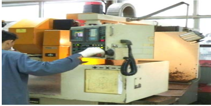
รูปที่ 3.16 การปรับแต่งการทำงานของเครื่องแกะสลักทำแม่พิมพ์
