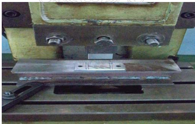
รูปที่ 3.87 ทำการขีดเส้นเพื่อบอกตำแหน่งระยะห่างของการปั้มขึ้นลอน
