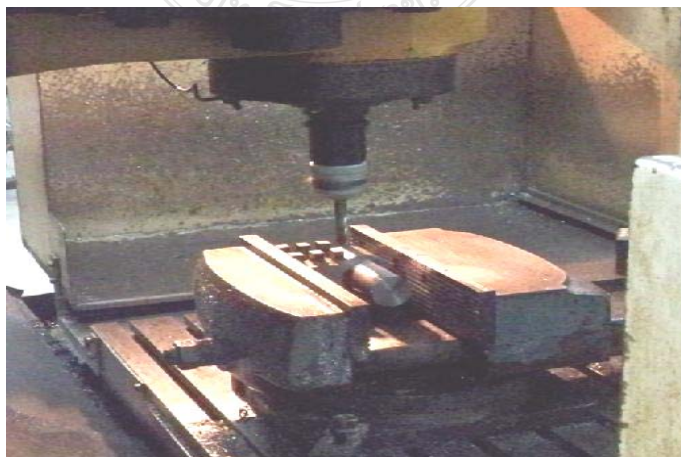
รูปที่ 3.76 การใช้ดอกสว่านเจาะแกนเหล็กเพื่อยึดสลัก
