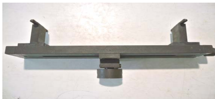
รูปที่ 3.38 อุปกรณ์ที่ใช้เป็นตัวทำการกดน้ำหนักบรรทุกแบบ 2 จุด
