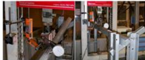
ก) ตำแหน่งที่ติดตั้งเครื่องมือวัด ข) ติดตั้งเครื่องมือวัดบนคานเอียง
