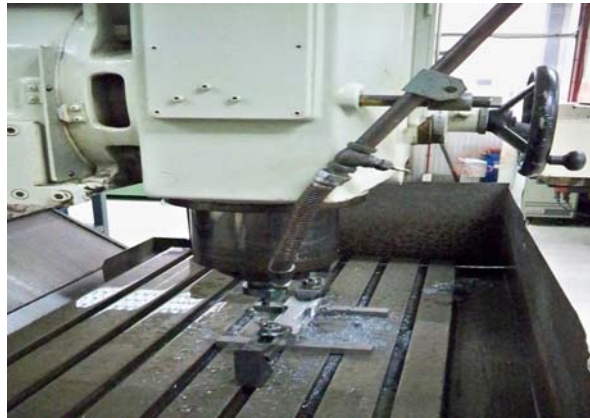
รูปที่ 3.107 การเตรียมชิ้นทดสอบด้วยเครื่องCNC
