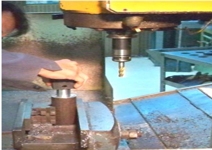
รูปที่ 3.74 ทดสอบประกอบหัวปั๊มแม่พิมพ์ตัวผู้ (Punch) กับแกนเหล็กยึดหัวปั๊มแม่พิมพ์
