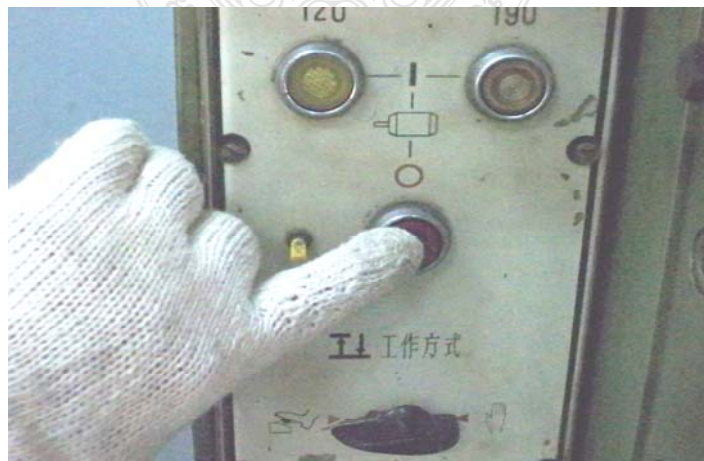
รูปที่ 3.93 การเปิดสวิตซ์การทำงานของเครื่องปั๊มข้อเสือ
