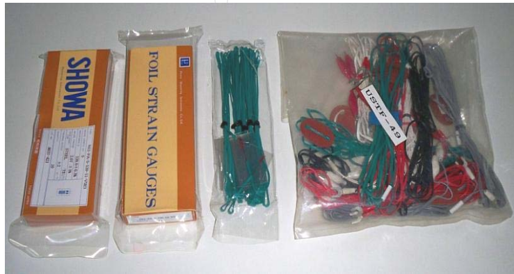
รูปที่ 3.29 Strain Gauges และชุดต่อสาย
