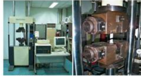
ค) เครื่องดึงเหล็กชื่อ DARTEC ง) หัวจับทำการดึงขึ้นทดสอบ
