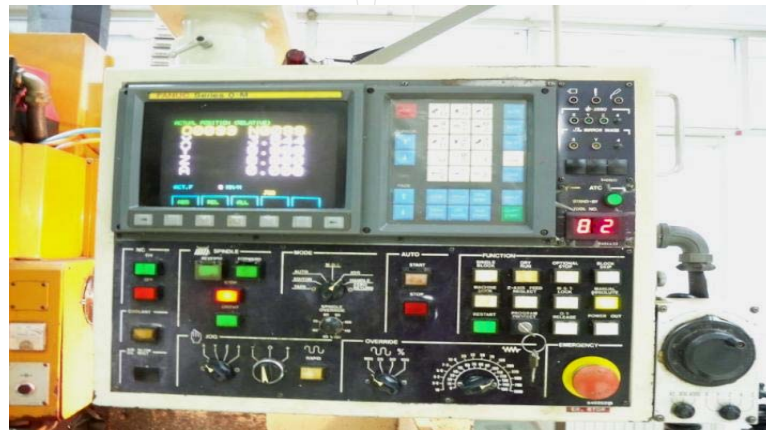
รูปที่ 3.14 หน้าจอชุดควบคุม (Monitor) เครื่องจักรสมองกล CNC Machine
