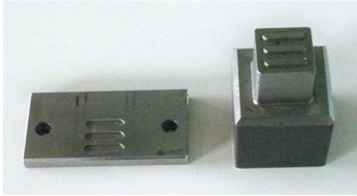
รูปที่ 3.25 แม่พิมพ์ปั๊มแนวอนสำหรับคานเหล็กขึ้นรูปเย็นหน้าตัด Hat Shape ชนิด TOP HATS
