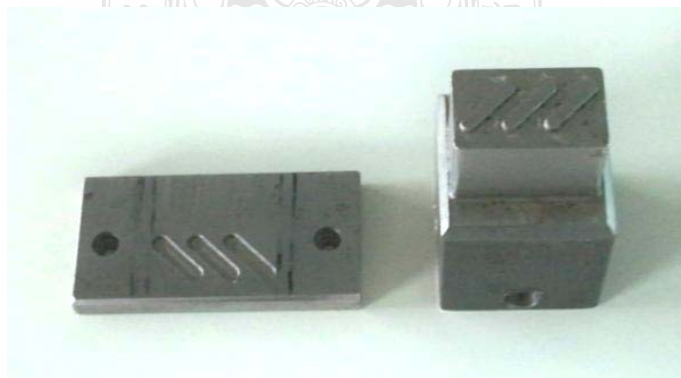
รูปที่ 3.27 แม่พิมพ์ปั๊มแนวเฉียงเอียงสำหรับคานเหล็กขึ้นรูปเย็นหน้าตัด Hat Shape ชนิด TOP HATS
