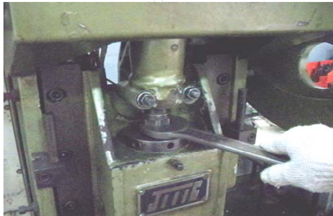
รูปที่ 3.89 ชั้นเหล็กแกนเพลาส่งกำลังของเครื่องปั๊มปรับระยะตั้งค่า Stroke (ขึ้น-ลง)
