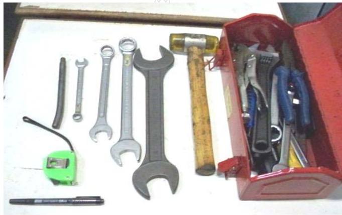
รูปที่ 3.80 เครื่องมือที่ใช้กับเครื่องปั๊มข้อเสื่อ (Mechanical Press)
