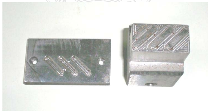
รูปที่ 3.24 แม่พิมพ์ปั๊มแนวเฉียงเอียงสำหรับคานเหล็กขึ้นรูปแผ่นหน้าตัด Hat Shape ชนิด TS 4048 TOP SPAN
