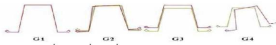
รูปที่ 17 หน้าตัดคาน Top Span ที่เกิดการเคลื่อนตัวเมื่อรับแรงกดคดและเกิดการเสถียรแบบ โกงคดรวม (Global Buckling)
