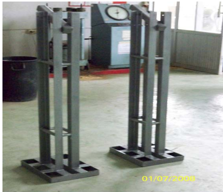
รูปที่ 3.34 จุจรงรับSupport เหล็ก โครงถักเอียงทำมุม 30 องศา
