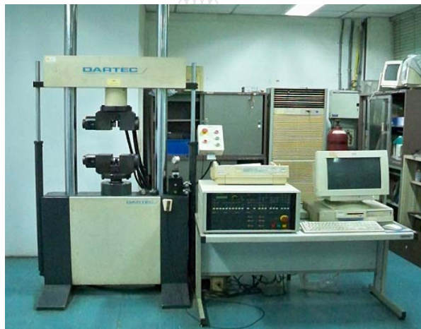
รูปที่ 3.108 เครื่องทดสอบการดึงเหล็กยี่ห้อDARTEC
