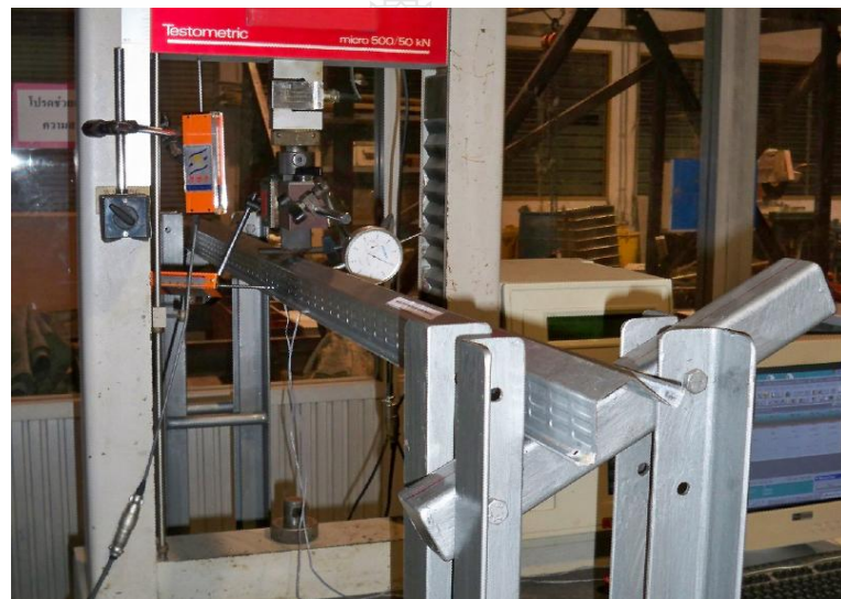
รูปที่ 3.42 ติดตั้งเครื่องมือวัดกลางคานวัดการเคลื่อนตัวขนาดรับแรงกดตัด บนจุดรองรับเอียงทำมุม 30 องศา
