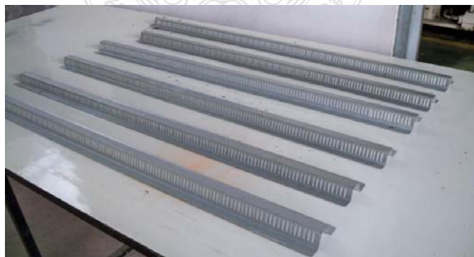
รูปที่ 3.102 ทำการป้อนชิ้นลอนด้านข้างของคานเหล็กขึ้นรูปยื่นหน้าตัด Hat Shape ชนิด TS 4048 TOP SPAN ที่เสร็จแล้ว
