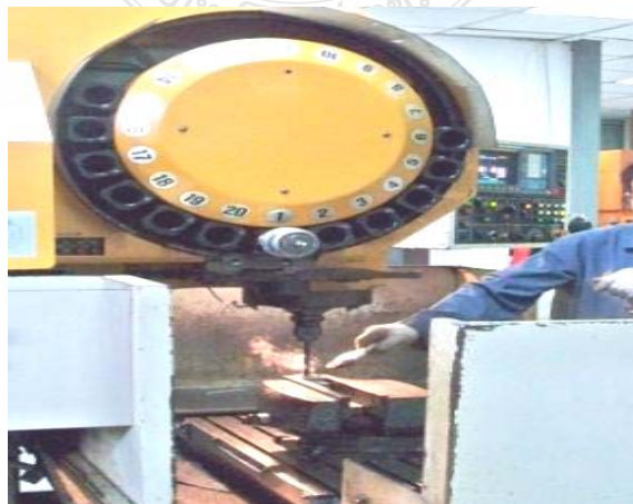
รูปที่ 3.21 ขนาดทำการเจาะหัวป้อนแม่พิมพ์ด้วยดอกกัดส่วนต้องทำการหล่อเย็นดอกสว่านด้วยน้ำมัน
