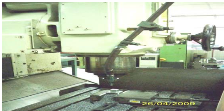
รูปที่ 3.18 การแกะสลักแม่พิมพ์ด้วยเครื่อง CNC ที่ต้องการความละเอียดของงาน
