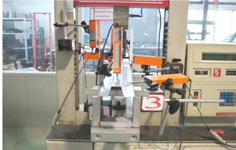
รูปที่ 3.45 ติดตั้งเครื่องมือวัดในตำแหน่งที่มีการเคลื่อนตัวและต้องการดูผลการเสียรูปของคานเหล็กรีดเย็น
