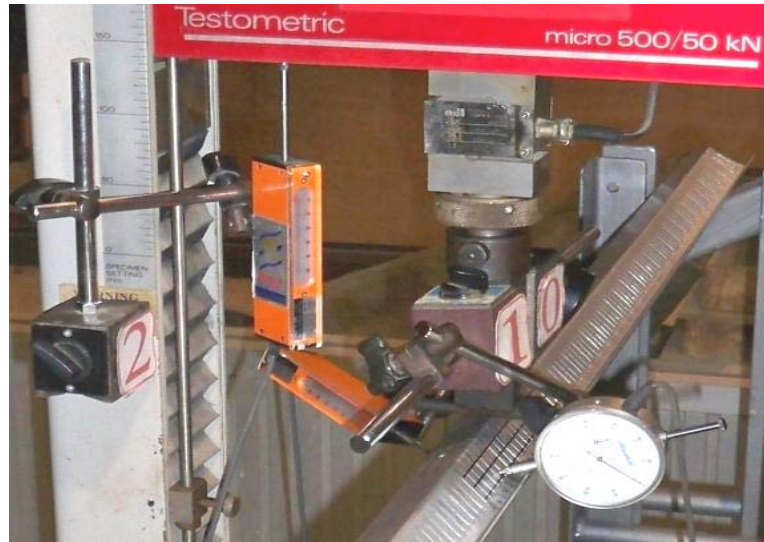
รูปที่ 3.41 ติดตั้งเครื่องมือวัดในตำแหน่งที่มีการเคลื่อนตัวและต้องการดูผลการเสียรูปของคานเหล็กรีดเย็น
