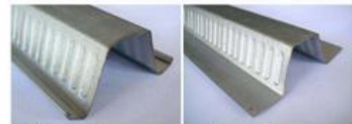
ก) ป้อนขึ้นลอนหน้าตัดแบบ Top Span ข) ป้อนขึ้นลอนหน้าตัดแบบ Top Hats ภาพที่ 8 การป้อนขึ้นลอนตัวอย่างคานหน้าตัดรูปทรงหามวกด้านข้างแนวตั้ง
