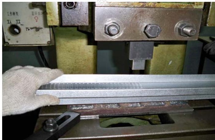
รูปที่ 3.95 ทำการทดสอบการป้อนขึ้นรูป เพื่อหาค่า Stroke ที่เหมาะสม
