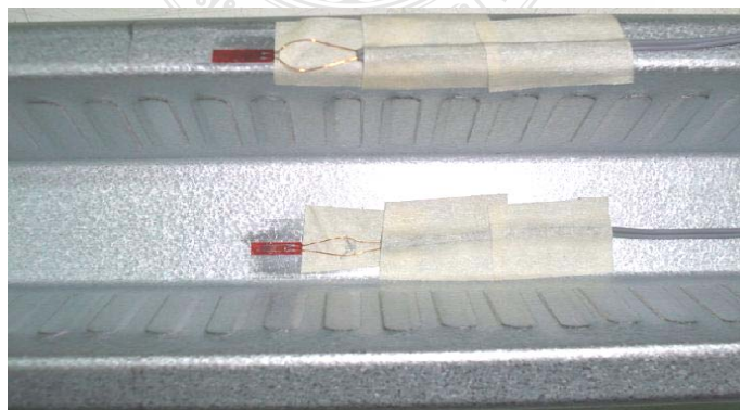
รูปที่ 3.131 ติดตั้ง Strain Gauges กลางคาน
