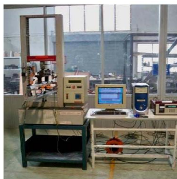
รูปที่ 6 เครื่องกค้ดชื่อ Testometric และเครื่องมือ อุปกรณ์ที่ใช้ทดสอบ
