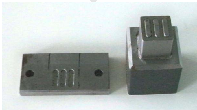
รูปที่ 3.26 แม่พิมพ์ปั๊มแนวตั้งสำหรับคานเหล็กขึ้นรูปเย็นหน้าตัด Hat Shape ชนิด TOP HATS
