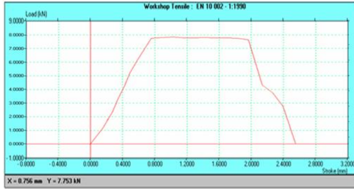
รูปที่ 4.2 แสดง Load กับการยืดตัว
