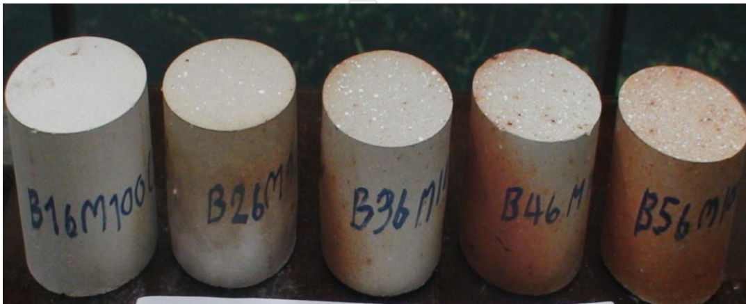
รูปที่ 4.3 ตัวอย่างชิ้นงานของถ่้าลอยอะลูมิเนียมหลังการเผาอุณหภูมิที่ 1,200 °C
