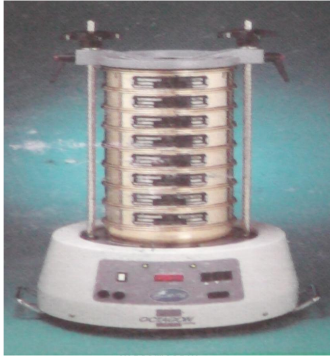
รูปที่ 2.1 ตะแกรงแบบส้นสำหรับหาปริมาณกากค้ำตะแกรง [9]
