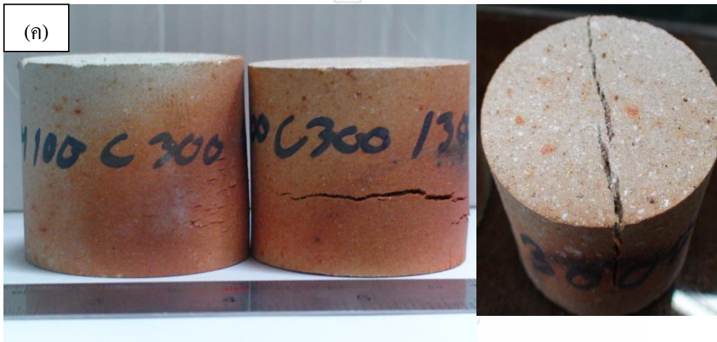
รูปที่ 4.4 ตัวอย่างชิ้นงานที่เสียหายหลังการเผาอุณหภูมิที่ 1,300 °C (ก) ตัวอย่างชิ้นงานบิตบวม (ข) ตัวอย่างชิ้นงานหดตัว และ (ค) ตัวอย่างชิ้นงานที่แตกร้าว
