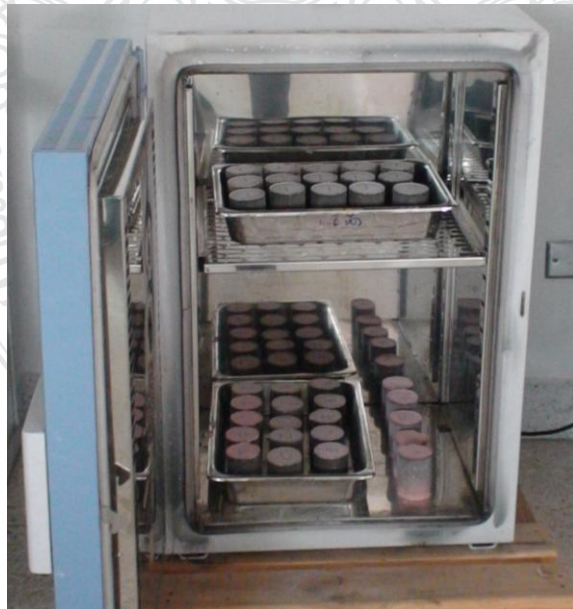
รูปที่ 3.17 การอบไล่ความชื้นของตัวอย่างชิ้นงานทดสอบ
