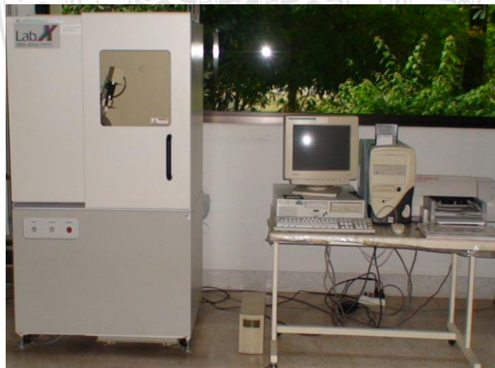
รูปที่ 3.4 เครื่องทดสอบวิเคราะห์โครงสร้างและสารประกอบ (X-Ray Diffractometer)
