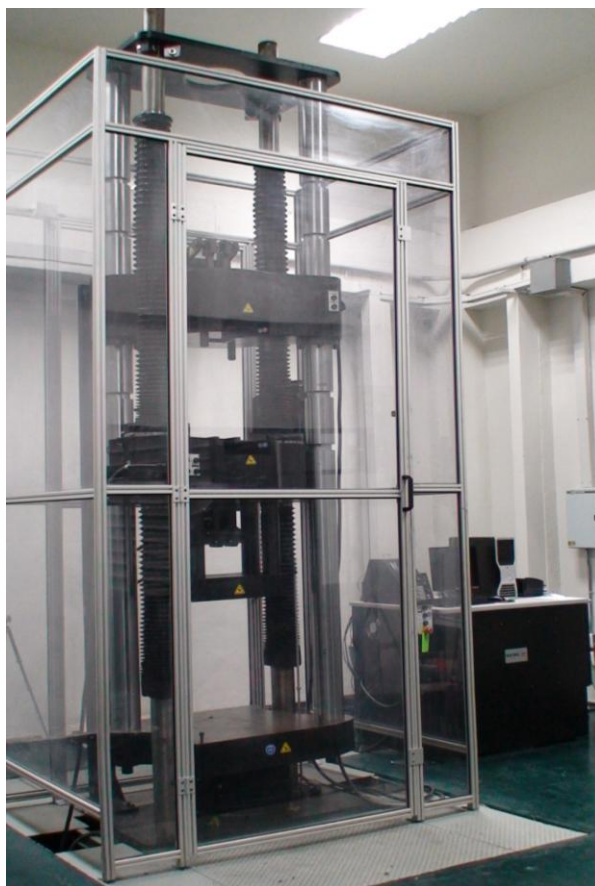
รูปที่ 2.2 เครื่องทดสอบแรงกด (Compression Test Instron SATEC Series.)
