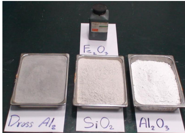
รูปที่ 3.9 วัตถุดิบและส่วนผสมของการผลิตอิฐทนไฟ
