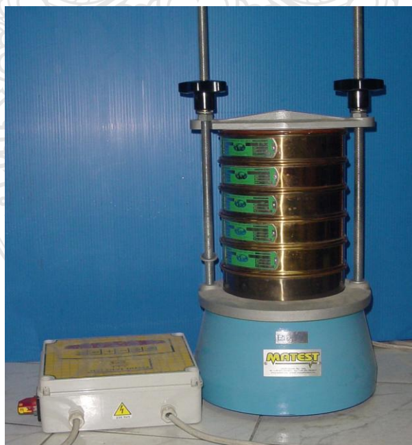
รูปที่ 3.5 เครื่องทดสอบการกระจายตัว (Test Sieve Analysis)
