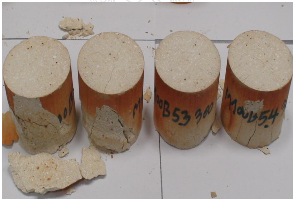
รูปที่ 3.31 ตัวอย่างชิ้นงานทดสอบที่เสียหายหลังการทดสอบ
