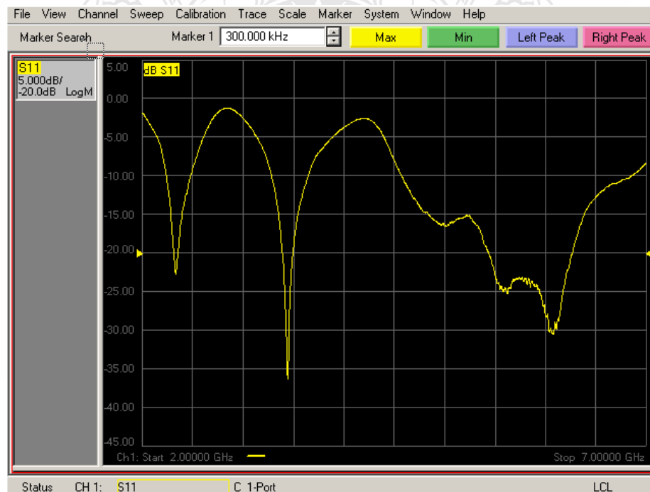
รูปที่ 4.3 การสูญเสียย้อนกลับจากการวัดด้วยเครื่องวิเคราะห์โครงข่าย
