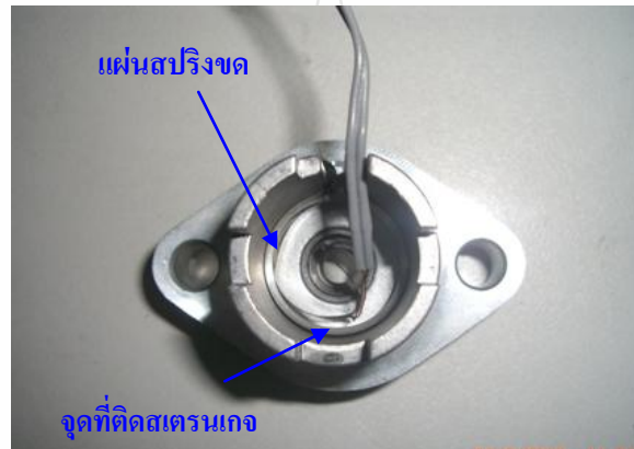
รูปที่ 3.8 การติดสเตรนเกจบนแผ่นสปริง
