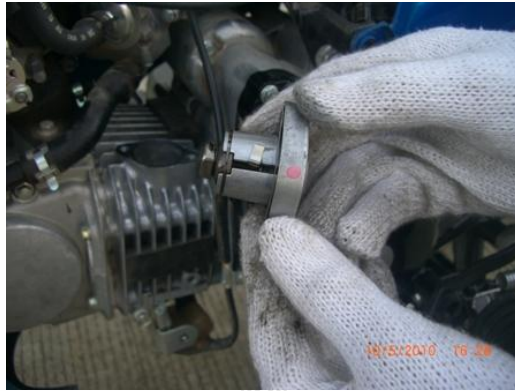
รูปที่ 3.1 การทดสอบชิ้นงานจริงเพื่อศึกษาสภาพความชำรุดของตัวปรับความตึงโซ่ [3]
