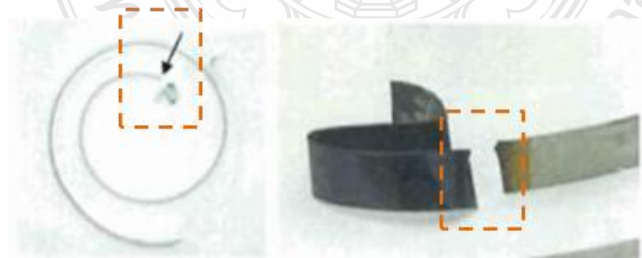
รูปที่ 5.3 ผลการตรวจความเสียหายจากชิ้นงานจริง
