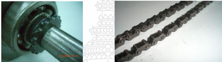
รูปที่ 1.5 ความเสียหายของเฟืองขับและโซ่ราวลิ้น [3]
