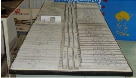
รูปที่ 3.9 ชั้นตัวอย่างมอร์ตาร์ที่บ่มในอากาศที่อุณหภูมิห้องเฉลี่ย 30 \pm 2 °C
