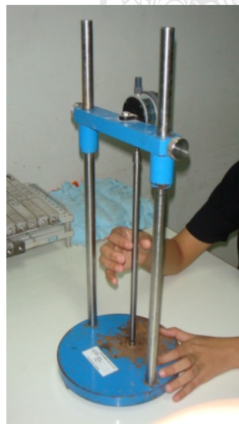
รูปที่ 3.8 การวัดความยาวของชั้นตัวอย่างเทียบกับแท่งโลหะความยาวคงที่มาตรฐาน
