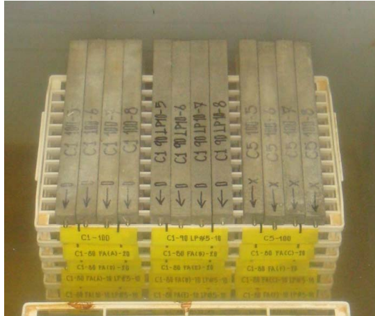
รูปที่ 3.23 ชิ้นตัวอย่างมอร์ตาร์ดที่แช่ในสารละลายโซเดียมซัลเฟตเพื่อทดสอบการขยายตัว
