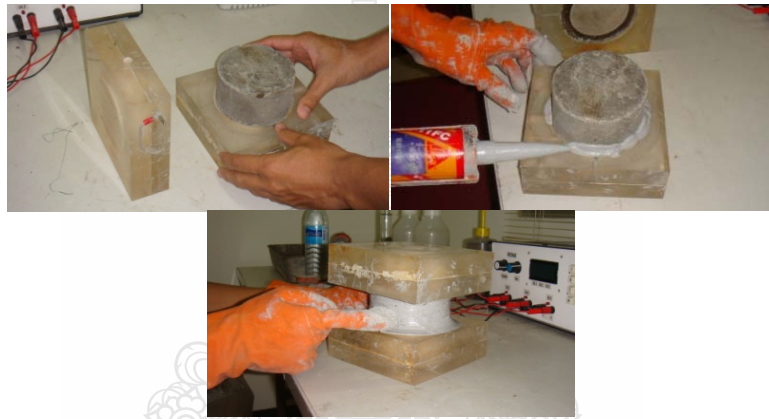
รูปที่ 3.19 การประกอบชิ้นตัวอย่างเข้ากับ Cell เพื่อเตรียมทดสอบการซึมผ่านคลอไรด์
