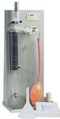
รูปที่ 3.2 เครื่องมือหาความละเอียดโดยวิธีแอร์เพอร์มีอะบิลิตีของเบลนด์
