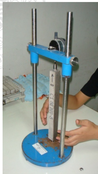
รูปที่ 3.8 การวัดความยาวของชั้นตัวอย่างเทียบกับแท่งโลหะความยาวคงที่มาตรฐาน
