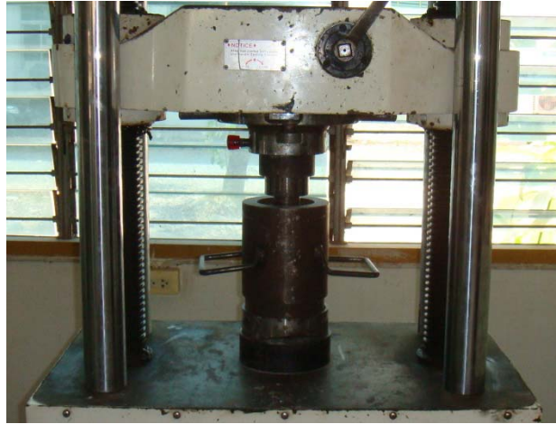
รูปที่ 3.14 การติดตั้งเครื่องมือรีดสารละลาย
