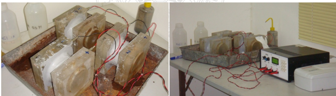
รูปที่ 3.20 การประกอบ Cell เข้ากับชุดทดสอบแบบแรงให้เกิดการแทรกซึมของคลอไรด์ไอออน
