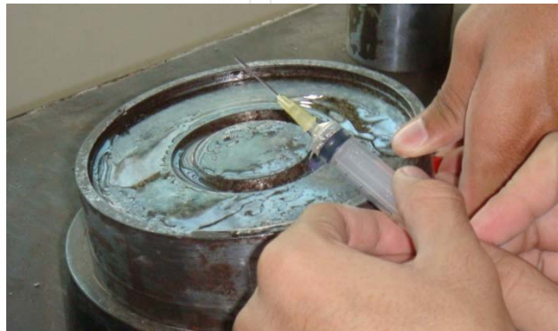
รูปที่ 3.15 สารละลายที่ถูกรีดออกจากภายในโพรงของชั้นตัวอย่างเพสต์
