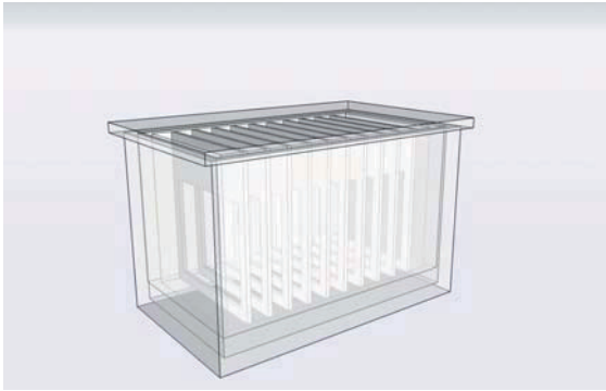
รูปที่ 3 แสดงโครงสร้างเครื่องแยกก๊าซไฮโดรเจนและออกซิเจน
