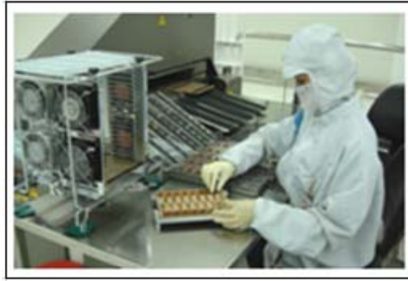
รูปที่ 4.16 การถอดแผ่นวงจรทั้ง 16 ชั้นจากแผ่นรองรับชิ้นงานลงสู่ตะแกรงสำหรับเครื่องล้าง
