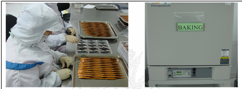
รูปที่ 4.3 การเรียงชิ้นงานใส่ถาดก่อนเข้านำถาดไปเข้าตู้อบเพื่อทำการอบชิ้นงาน
