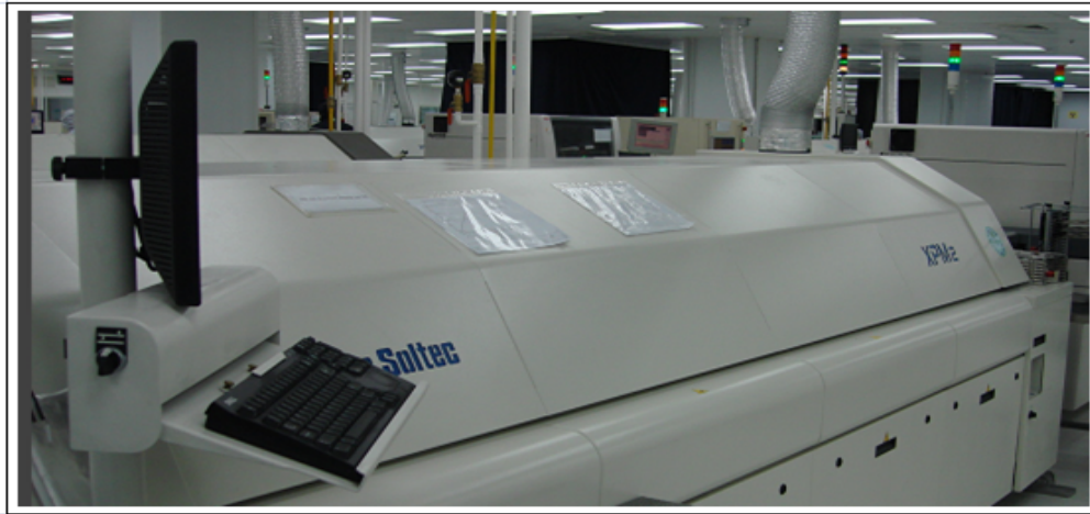
รูปที่ 4.10 เครื่องอบความร้อนที่มีลักษณะเป็นสายพาน (Reflow Machine)
