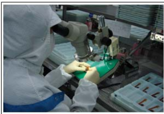
รูปที่ 4.20 ขั้นตอนตรวจสอบงานด้วยสายตาโดยใช้กล้องจุลทรรศน์ กำลังขยาย 10 เท่า
