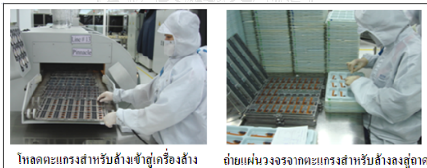
รูปที่ 4.17 ขั้นตอนการไหลตะแกรงและการเก็บแผ่นวงจรจากตะแกรงสู่ถาด
