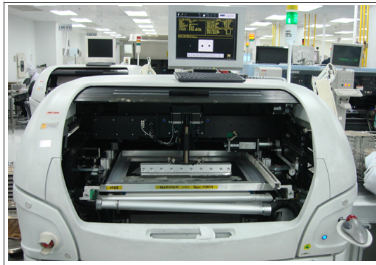
รูปที่ 4.4 เครื่องพิมพ์ตะกั่ว (Solder Paste Printing Machine)
