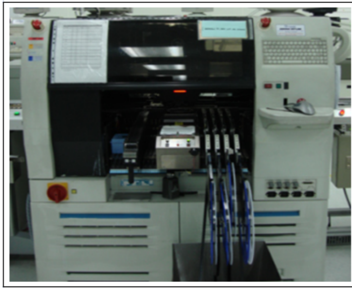
รูปที่ 4.8 เครื่องวางชิ้นส่วน IC Preamp (IC Preamp Placement Machine)
