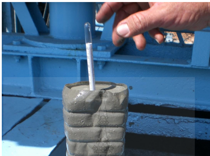
ภาพที่ ฉ.5 การตรวจสอบคุณภาพของส่วนน้ำปูนก่อนส่งเข้าไปที่ก้านเจาะ
