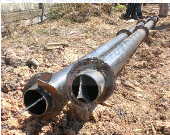
ภาพที่ 3.5 เหล็กกลม ขนาดเส้นผ่านศูนย์กลาง 4 นิ้ว หนา 4.0 มิลลิเมตร ยาว 6 เมตร
