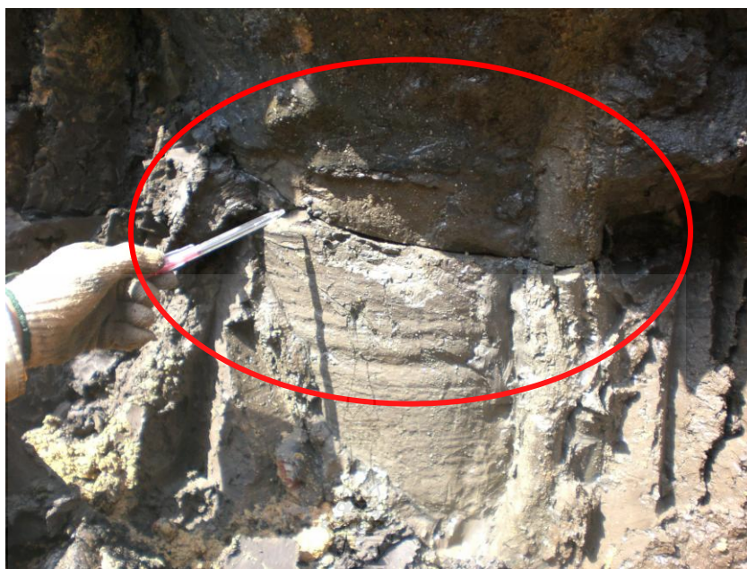
ภาพที่ 4.24 ร่องรอยการวิบัติของเสาเข็มดินซีเมนต์ที่เสริมแกนท่อเหล็กกลม (C7)
