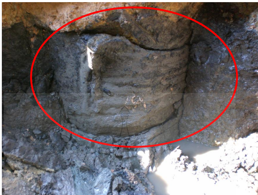
ภาพที่ 4.22 ร่องรอยการวิบัติของเสาเข็มดินซีเมนต์ที่เสริมแกน H Beam (C5)
