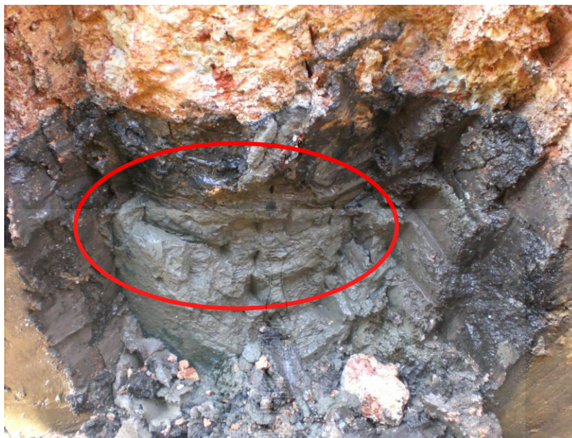
ภาพที่ 4.20 ร่องรอยการวิบัติของเสาเข็มดินซีเมนต์ที่ไม่มีการเสริมแกน (C3)
