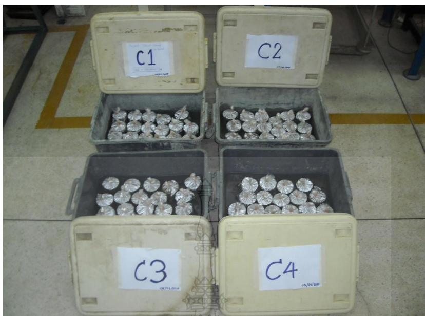
ภาพที่ ฌ.13 ตัวอย่างของเนื้อเสาเข็มที่นำไปทดสอบในห้องปฏิบัติการ
