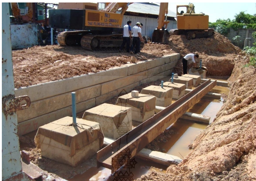
ภาพที่ ฌ.19 ลักษณะ Reaction Wall และ คานอ้ำงอิง
