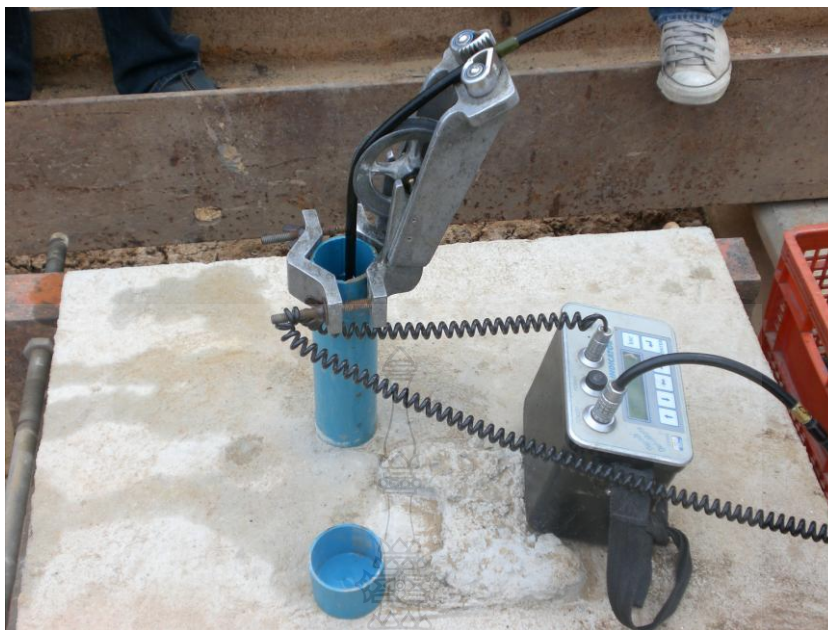
ภาพที่ ฌ.23 การติดตั้ง Digitilt Inclinometer เพื่อวัดการเคลื่อนตัวในแนวตั้ง
