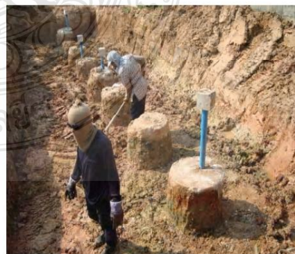
รูปที่ 3 SDCM Column ในแปลงทดสอบ
