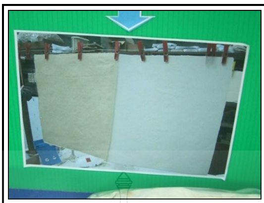
ภาพที่ 3.15 ลอกกระดาษออกจากแบบไม้แล้วนำไปฟุ้งลม
