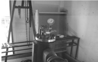
รูปที่ 7 หม้อต้มแรงดัน
