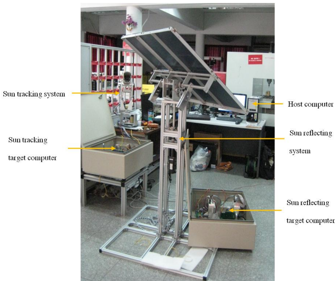
รูปที่ 3.16 ระบบติดตามดวงอาทิตย์และระบบสะท้อนแสงอาทิตย์ที่ใช้ในการทดลอง
