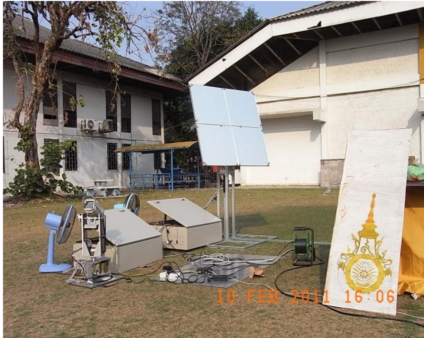
รูปที่ 4.4 การทดลองระบบติดตามดวงอาทิตย์และระบบสะท้อนแสงอาทิตย์
