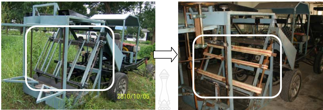
รูปที่ 4.3 การปรับเปลี่ยนระบบลำเลียงเป็นสายพานโรงสี
