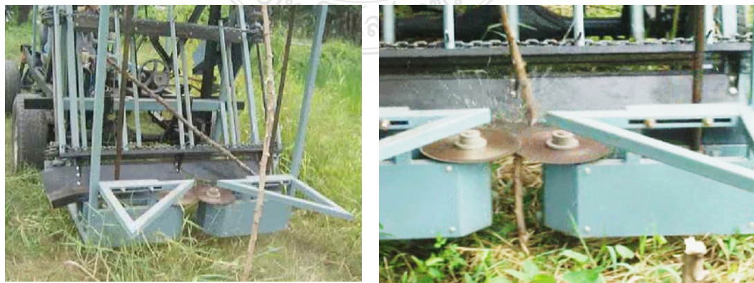
รูปที่ 4.4 การทดสอบเครื่องต้นแบบในสถานะที่มีภาระกระทำ
