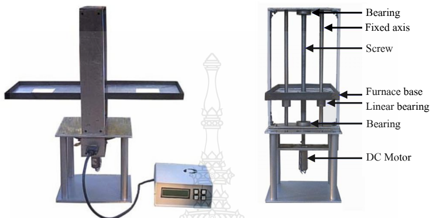
ภาพที่ 2.15 องค์ประกอบของเตาปลูกผลึกที่พัฒนาระบบการยกเตา [8]
