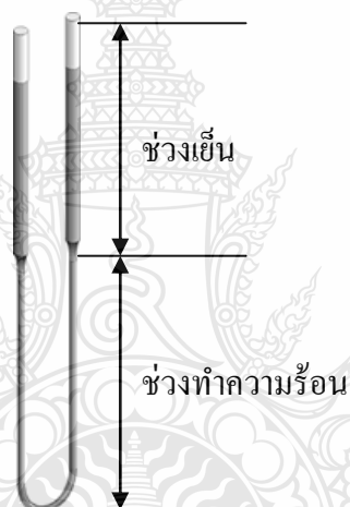
ภาพที่ 2.8 ช่วงทำความร้อนช่วงเย็นของลวดความร้อน
