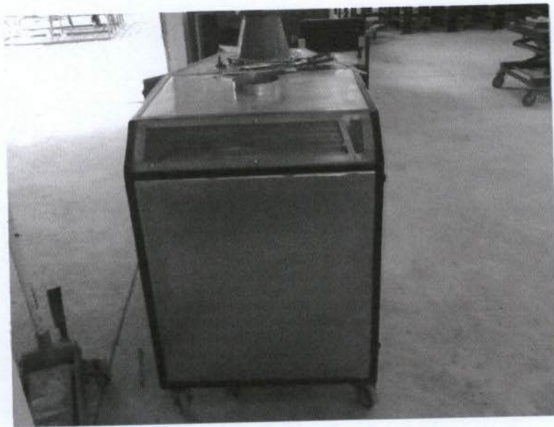
รูปที่ 3.2 เครื่องกรองอากาศสำหรับอุตสาหกรรมอบชุบโครเมียม
