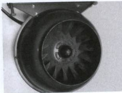
รูปที่ 3.12 Blower
