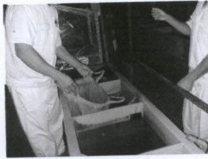
รูปที่ 4.1 การล้างหลังจากการชุบโครเมียม
