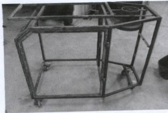
รูปที่ 3.4 โครงเครื่องกรองอากาศสำหรับอุตสาหกรรมอบชุบโครเมียม
